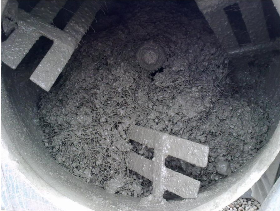
Fotografía 11. Aspecto de la mezcla con p_f = 2,0\%
