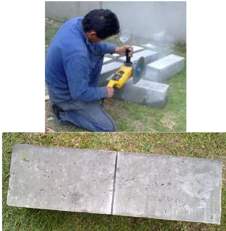
Fotografía 4. Realización de fisura inducida
