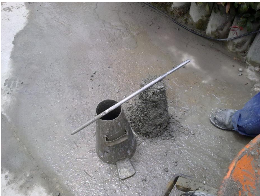
Fotografía 12. Asentamiento nulo de mezcla con fibra p_f = 2,0\%
