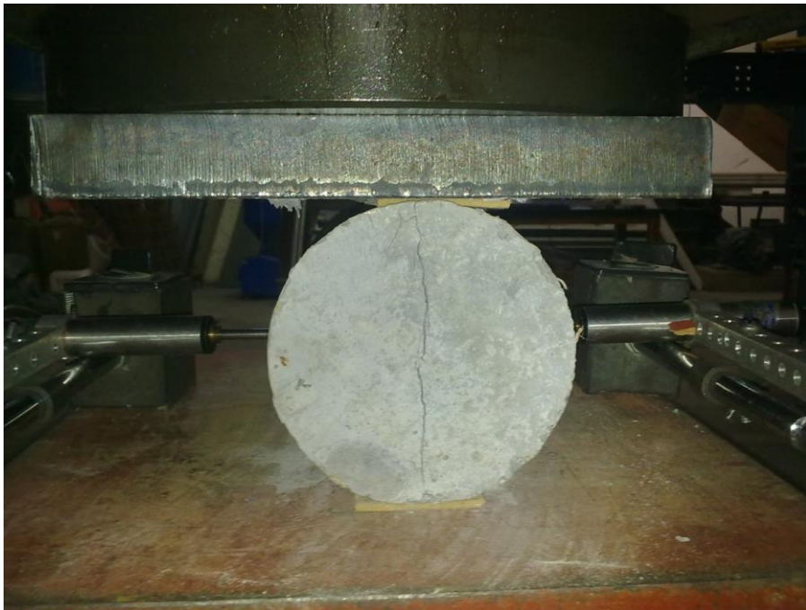
Fotografía 23. Aspecto del inicio del ensayo de tracción indirecto
