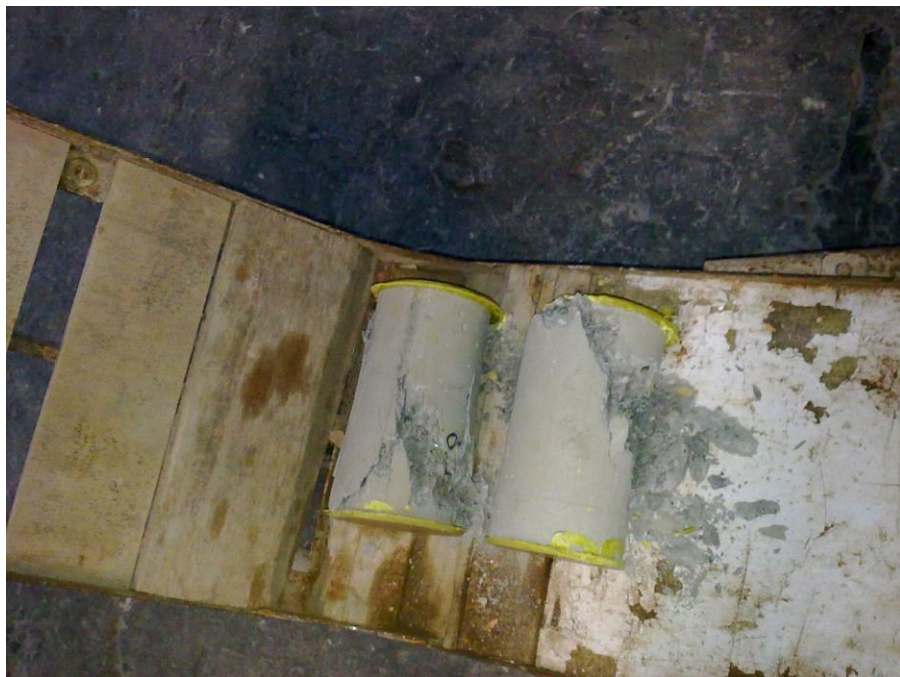
Fotografía 14. Aspecto de los cilindros fallados
