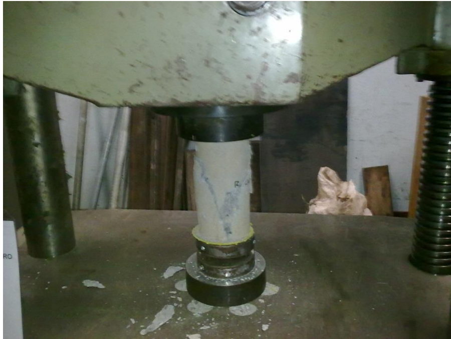
Fotografía 13. Falla diagonal en un cilindro a compresión
