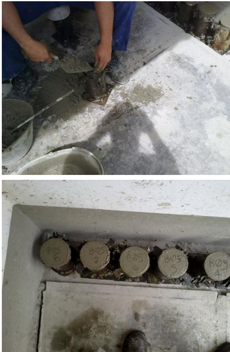
Fotografía 1. Construcción probetas cilíndricas
