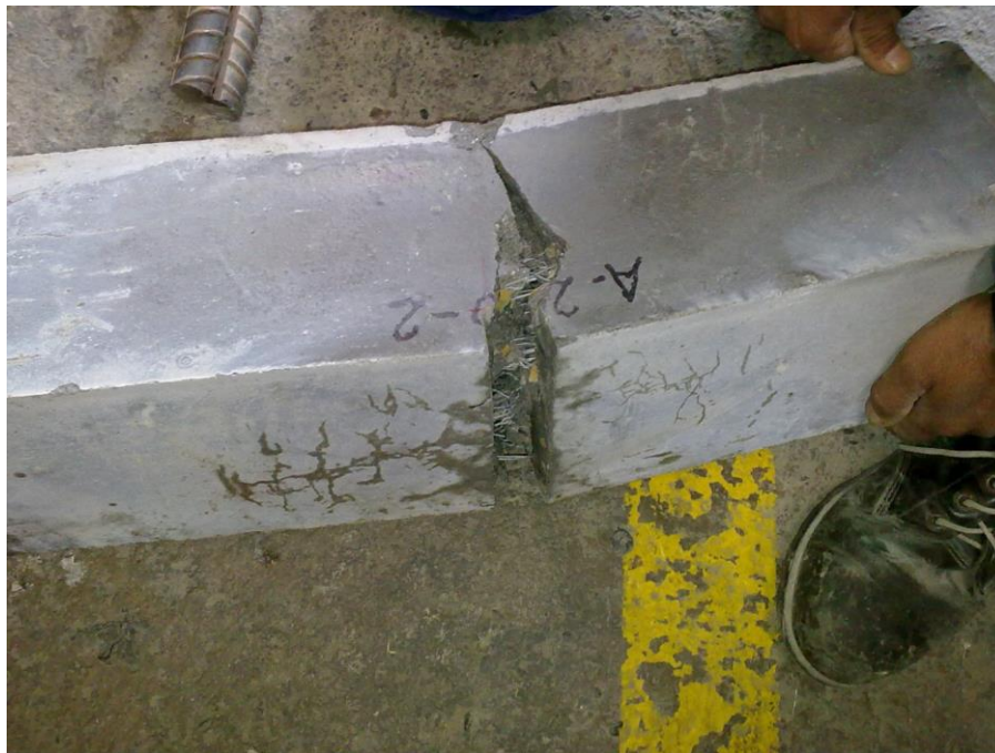
Fotografía 20. Aspecto de una viga con \rho_f = 2,0\% fallada a flexión
