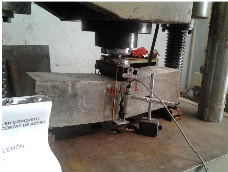
Fotografía 21. Aspecto de una viga al final del ensayo de flexión \rho_f=0,5\%
