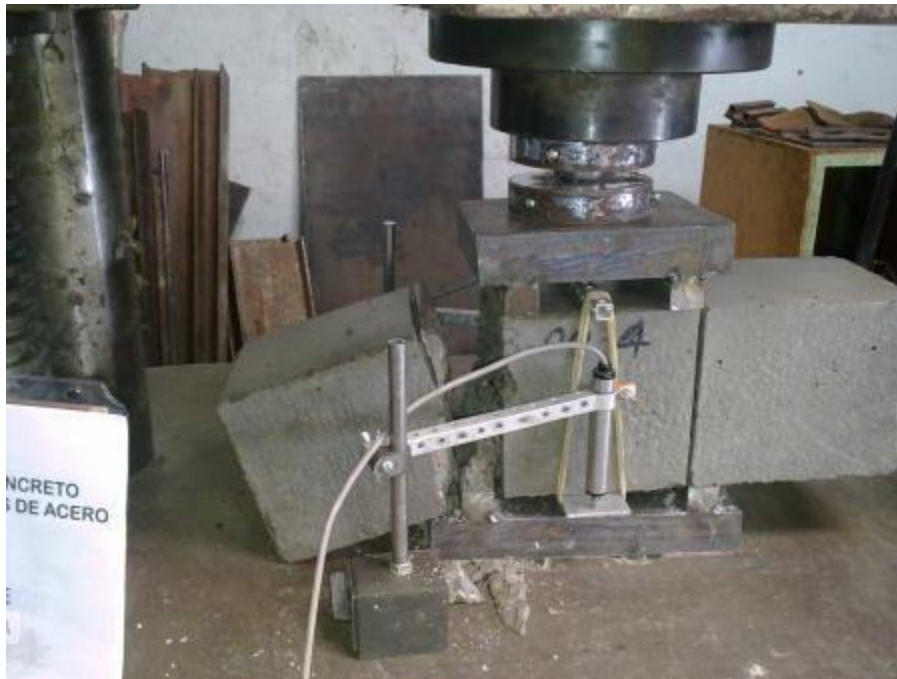
Fotografía 27. Colapso de una vigueta a corte sin fibra
