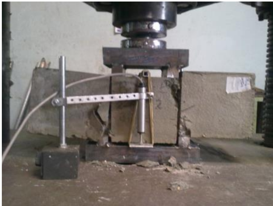
Fotografía 28. Colapso de una vigueta con \rho_f = 0.5\%
