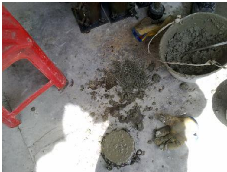
Fotografía 2. Testigos de concreto simple con retiro manual de fibra
