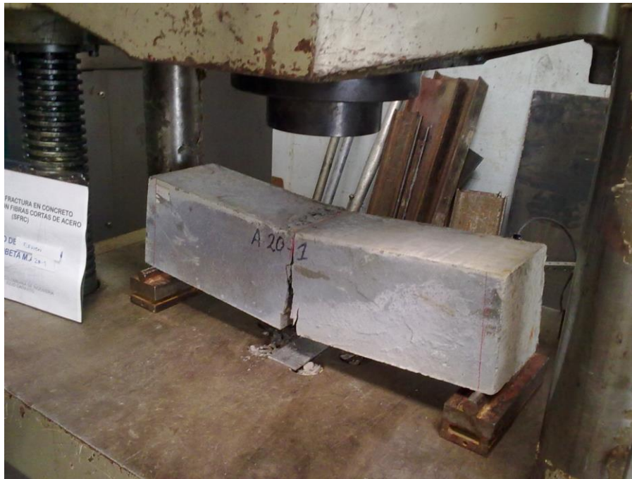
Fotografía 19. Estado de equilibrio de una viga fallada a flexión con \rho_f = 2,0\%
