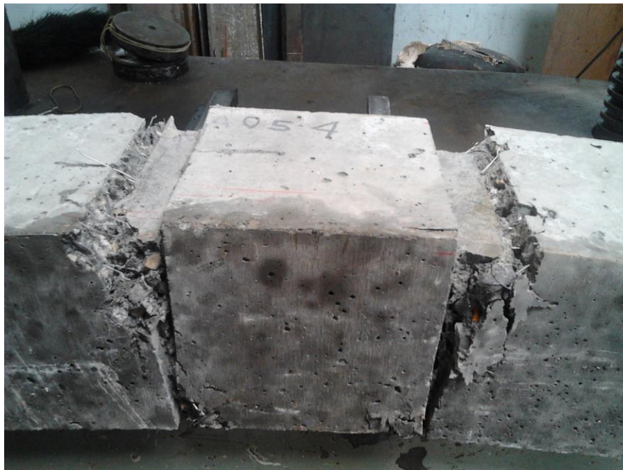
Fotografía 30. Daño en los apoyos por aplastamiento p_f=0,5\%
