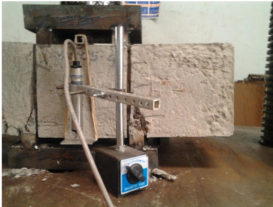
Fotografía 29. Daño en los apoyos en una vigueta a cortante
