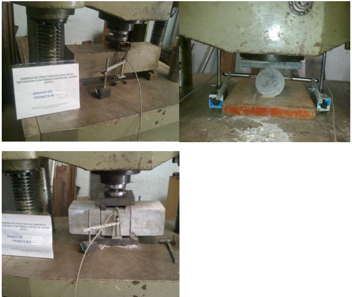
Fotografía 10. Localización de los deformímetros en los ensayos
