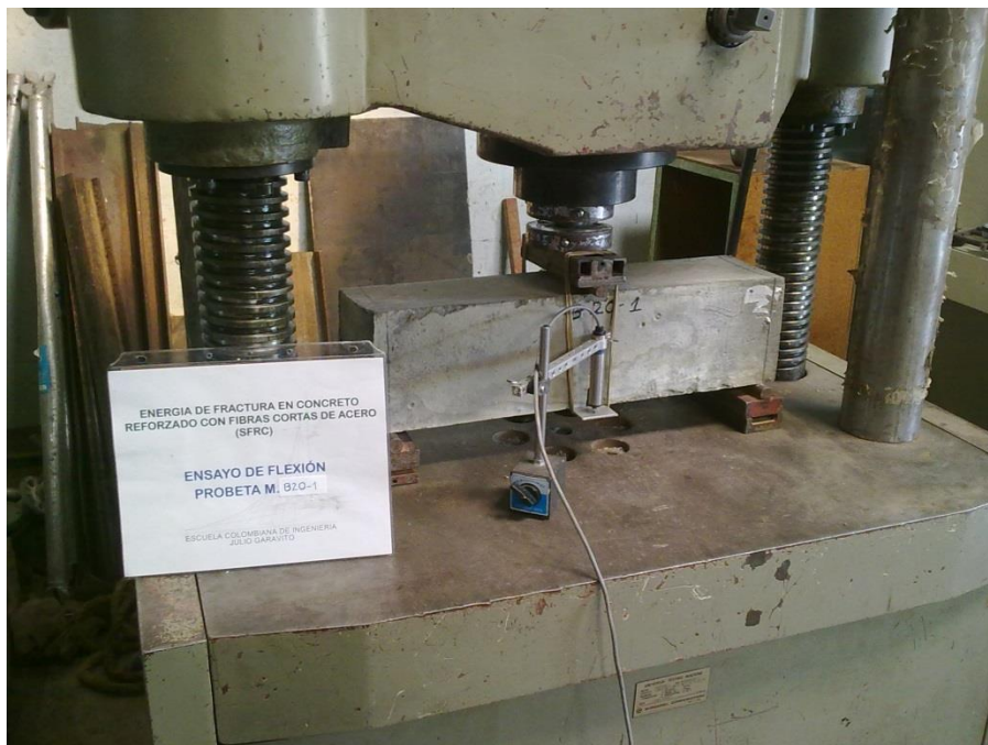
Fotografía 16. Ensayo de flexión estado inicial
