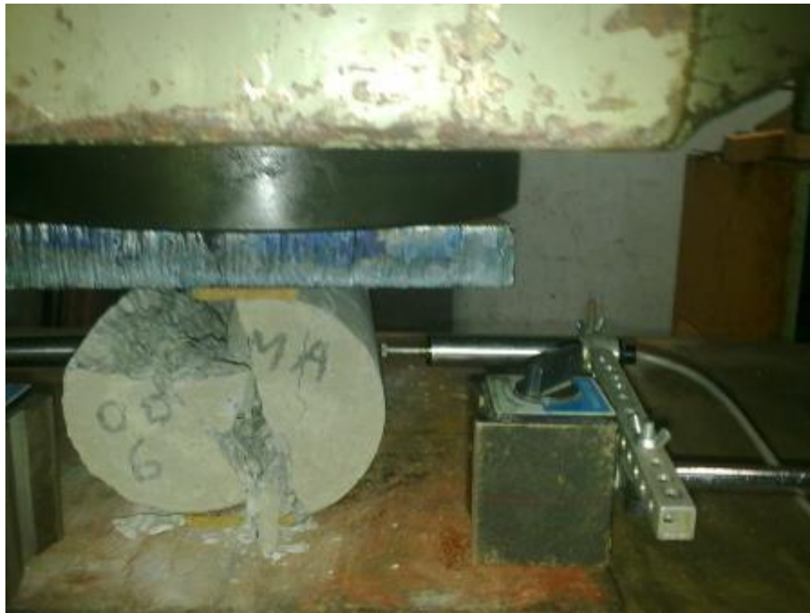
Fotografía 25. Colapso de probeta de concreto simple a tracción indirecta
