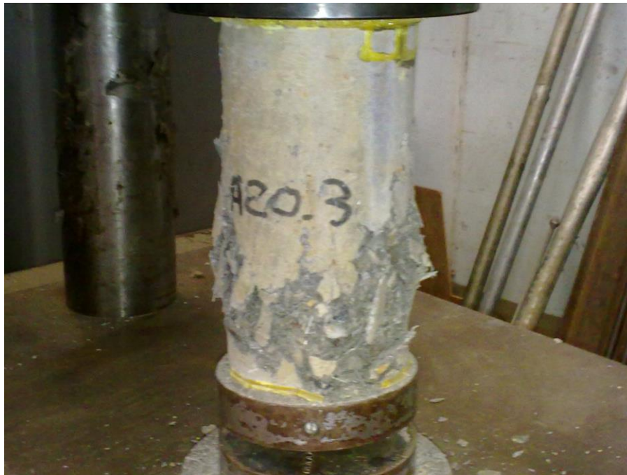
Fotografía 15. Falla de cilindro con \rho_f = 2.0\% antes de estallar
