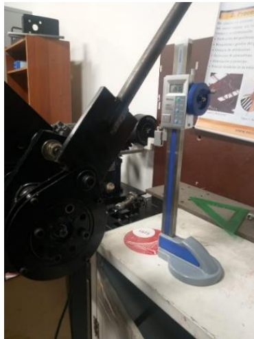
Figura 19. Configuración de máquina dobladora y sensor de torque.
