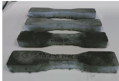
Figura 1.2 - Cuerpo de prueba dogbone para ensayo de tracción directa conforme a JSCE-08 [2][3]
