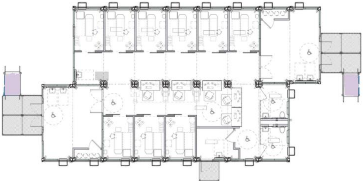
Figura 14. Instalación temporal para pacientes hospitalizados con puertas corredizas sólidas en las habitaciones de pacientes de COVID que permiten lograr un tratamiento con filtro HEPA localizado del aire en la habitación y un aumento de los cambios de aire [2].
