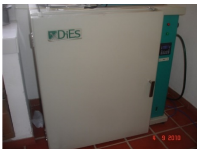
Fotografía 20. Cámara de carbonatación, Escuela Colombiana de Ingeniería
