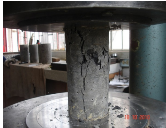
Fotografía 10. Ensayo resistencia a la compresión. Cilindro fallado.
