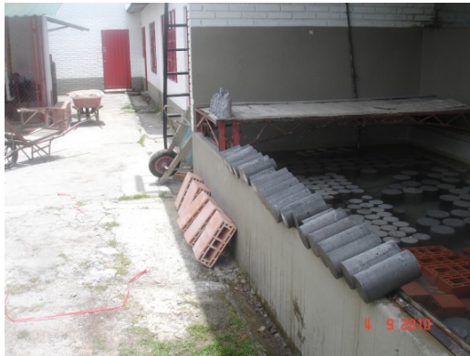
Fotografía 4. Curado de los cilindros sumergidos en agua. E.C.I.
