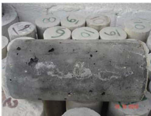
Fotografía 19. Especímenes con Ettringita o sal de Candlot
