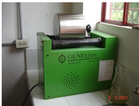
Fotografía 8. Máquina Micro Deval . E.C.I.
