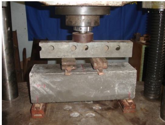
Fotografía 12. Montaje prueba de flexión vigueta (500 x 150 x 150 mm)
