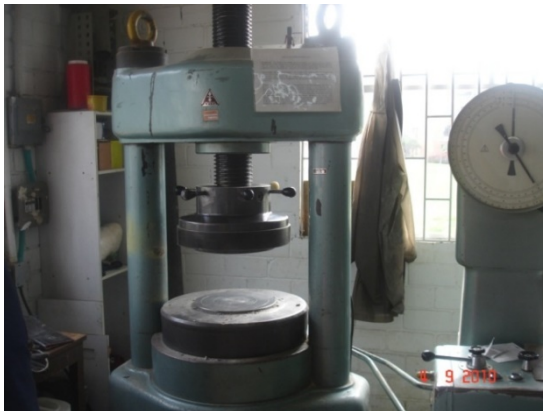
Fotografía 9. Prensa hidráulica 200 t. Escuela Colombiana de Ingeniería.
