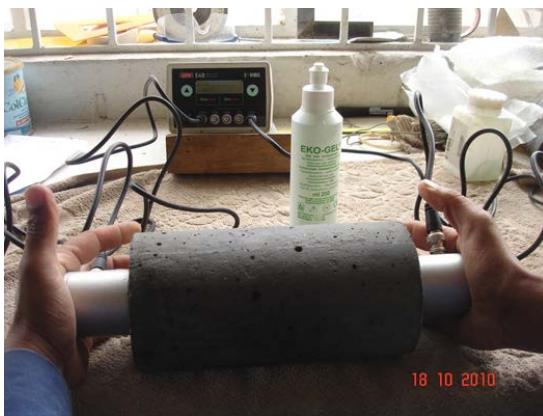
Fotografía 13. Equipo de pulso ultrasónico E.C.I. y esquema (Mindess y Young).
