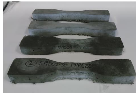
Figura 1.1 - Cuerpo de prueba dogbone para ensayo de tracción directa conforme a JSCE-08 [11][4]
