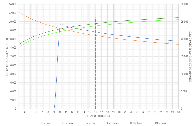
Gráfica 7-42. Purga de lodos y Demanda de oxígeno para sistema UTC vs edad de lodos para temperatura mínima y máxima con tratamiento primario.
