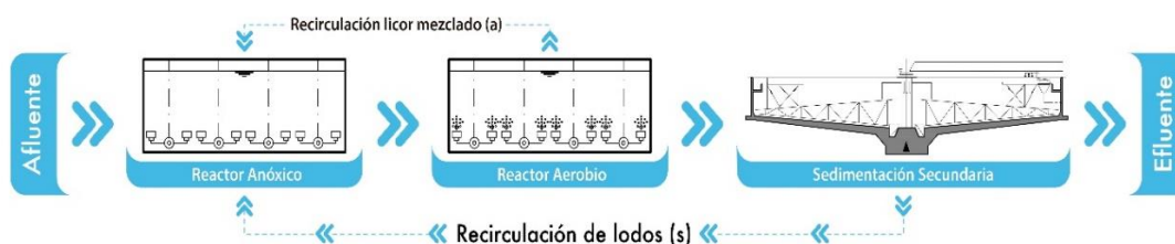
Figura 6-2 Configuración de un sistema MLE
