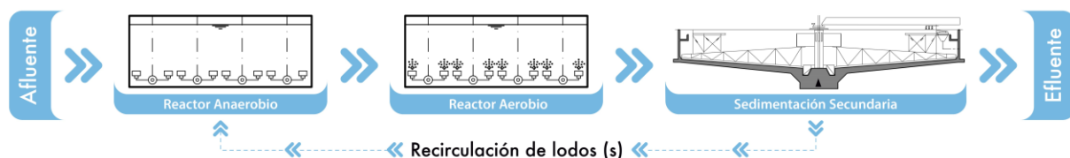
Figura 6-3 Configuración de un sistema A/O
