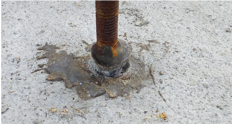
*Figura 40: Falla por adherencia de anclaje  $\Phi 1/2''$  a profundidad de embebido igual a 50 mm. Fuente: Autor.*
