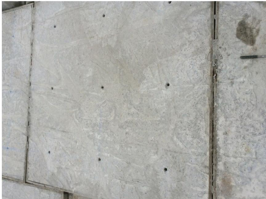
**Figura 10: Losas demarcadas con las perforaciones para ensayos a tensión. Fuente: Autor.**
