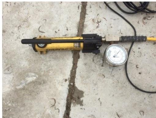
*Figura 22: Bomba hidráulica Fuente: Autor.*
