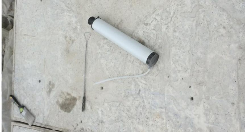
*Figura 15: Soplador para la limpieza de la perforación con aire a presión, cepillo de cerdas de alambre. Fuente: Autor.*
