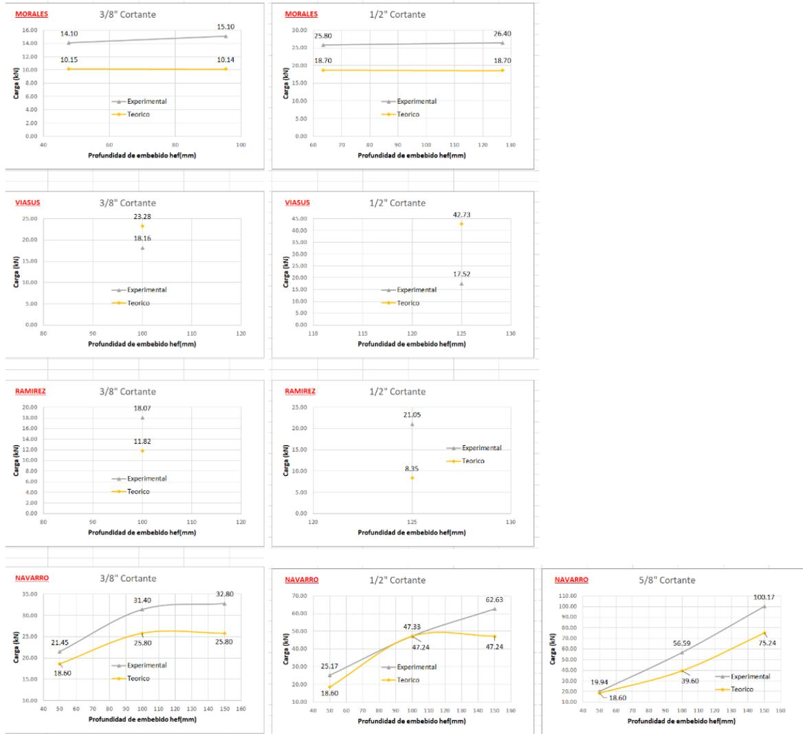
Figura 67. comparación de Anclajes a cortante. Fuente: Propia.
