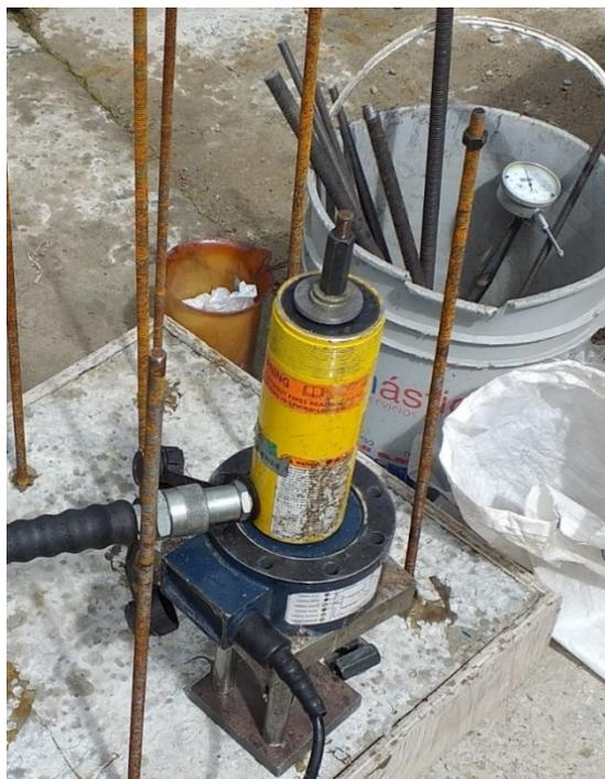
**Figura 38:** Anclaje  $\Phi 3/8"$  en ensayo confinado a tensión. Falla por adherencia. Fuente: Autor.
