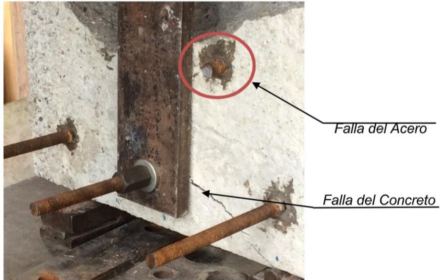
*Figura 52: Ensayo de Cortante  $\Phi 1/2$ ". Corte total del anclaje por falla del acero. En este ensayo se presenta Falla del concreto.*
