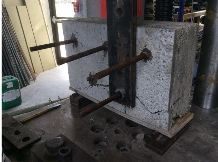
*Figura 25: Montaje final para ensayos a cortante. Fuente: Autor.*
