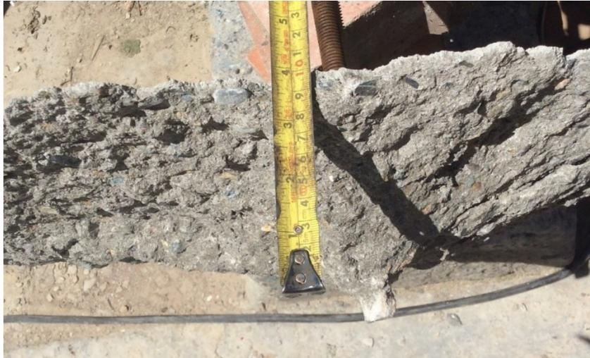
*Figura 45: Falla por arrancamiento del concreto con extracción de anclaje  $\Phi 5/8$ " a profundidad de embebido de 100 mm.*
