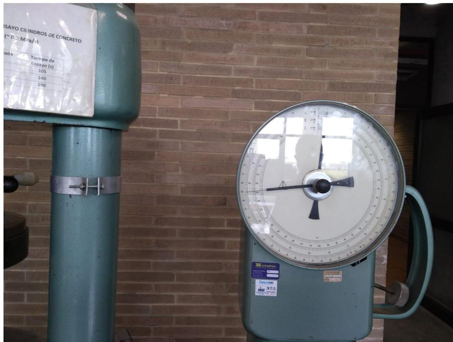
*Figura 71: Valor de la Carga de falla (39 Ton). Fuente: Autor.*
