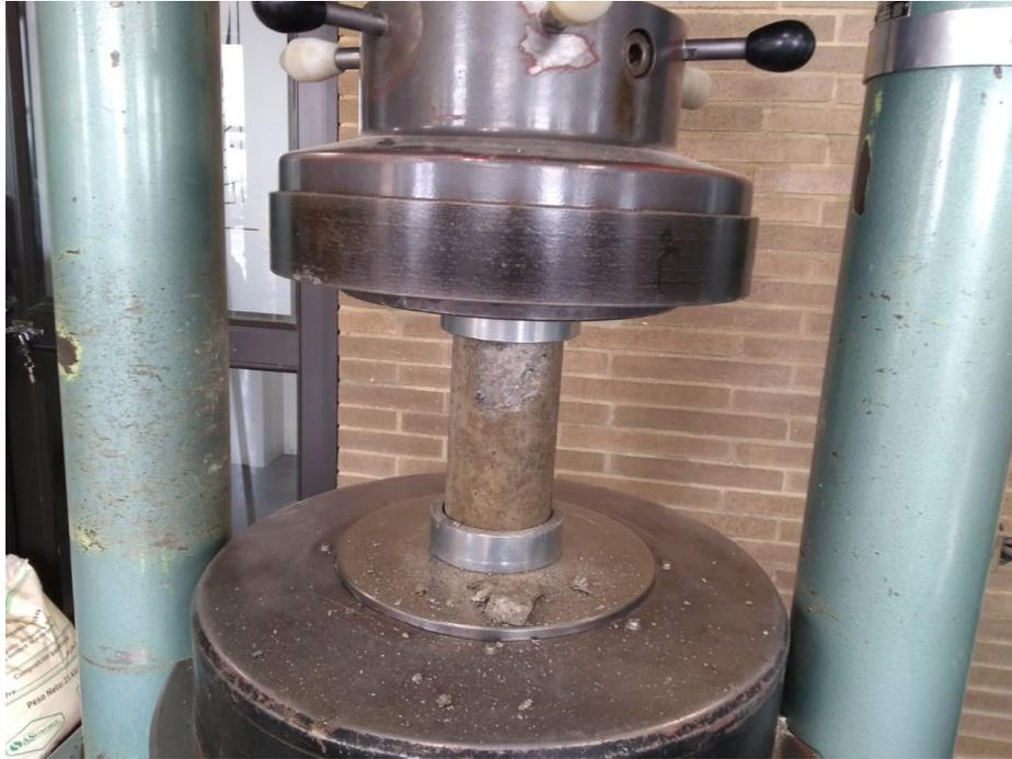
*Figura 70: Cilindro de concreto ensayado a compresión después de los 28 días. Fuente: Autor.*
