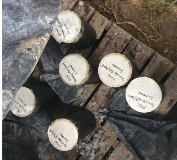
**Figura 9: Toma de muestras en cilindros. Fuente: Autor.**
