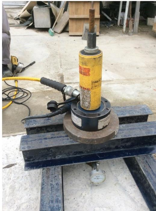
*Figura 19: Montaje Final para ensayos no confinados a tensión. Fuente: Autor*
