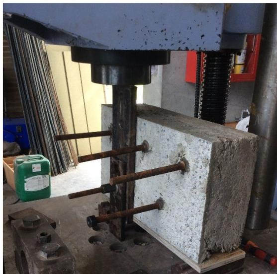
*Figura 51: Anclaje  $\Phi 1/2$ " ensayo a corte. Falla del acero. Fuente: Autor.*
