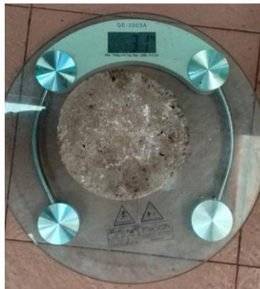
*Figura 73: Peso de un cilindro en estado seco (3.1 Kg). Fuente: Autor*
