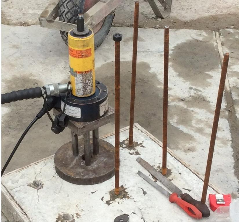
*Figura 39: Anclaje  $\Phi 1/2''$  en el momento de realizar el ensayo confinado a tensión. Falla por adherencia. Fuente: Autor.*
