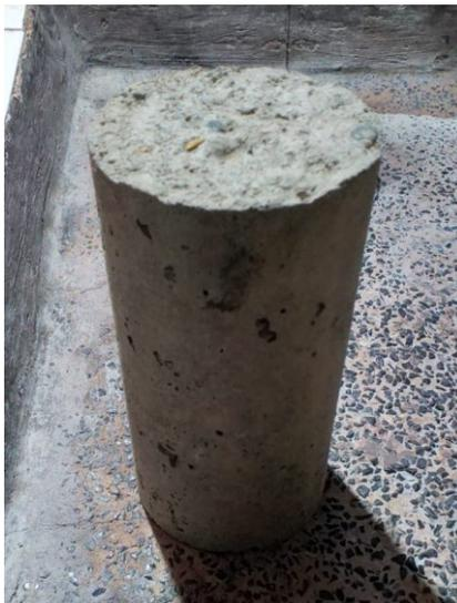
*Figura 69: Cilindro de concreto liviano antes de someterlo a la prueba de compresión. Fuente: Autor.*
