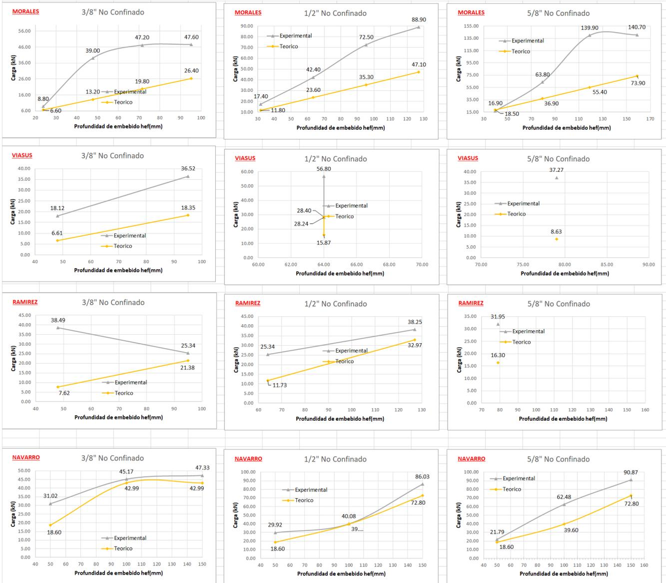
Figura 63. Comparación de Anclajes No confinados a tensión. Fuente: Propia.
