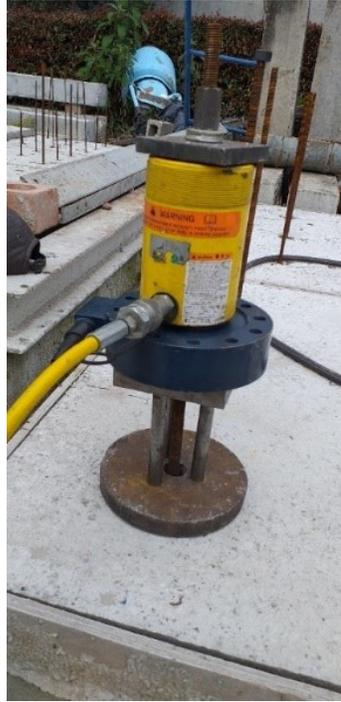
*Figura 21: Montaje final para ensayos confinados a tensión. Fuente: Autor.*
