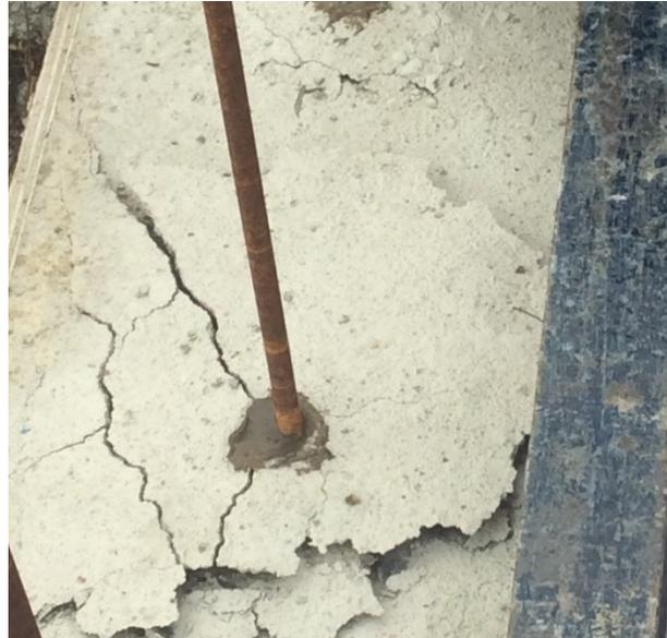
**Figura 44:** Falla por arrancamiento del concreto  $\Phi 1/2"$  a profundidad de embebido 150 mm. Fuente: Autor.
