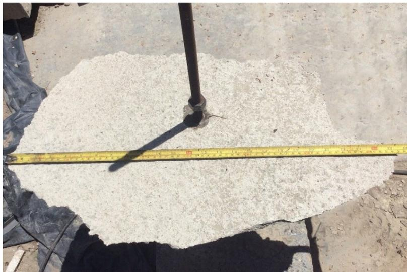
*Figura 46: Falla por arrancamiento del concreto con extracción de anclaje  $\Phi 5/8$ " a profundidad de embebido de 150 mm.*
