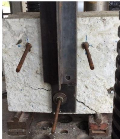
*Figura 50: Anclaje  $\Phi 1/2''$  ensayo a corte. Falla del Concreto. Fuente: Autor.*
