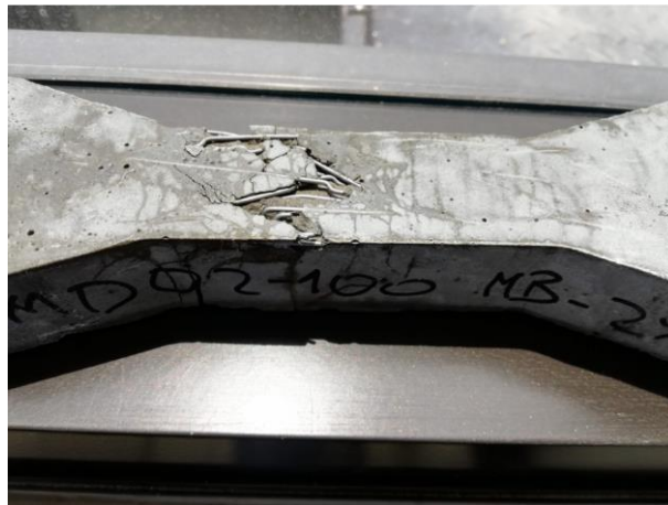
Figura 5-16. Microfisuración en probetas de UHPFRC con fibra metálica con gancho en los extremos (MB)
