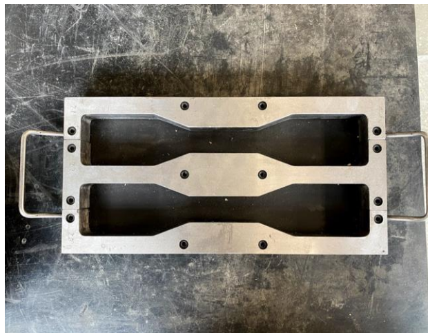
Figura 4-3. Moldes para la elaboración de las probetas tipo hueso de perro
