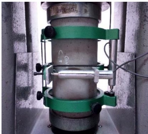
Figura 1-9. Ensayo a compresión de cilindros
