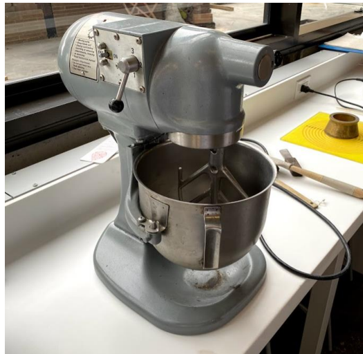
Figura 4-2. Mezcladora tipo Hobart de 3.0 litros de capacidad.
