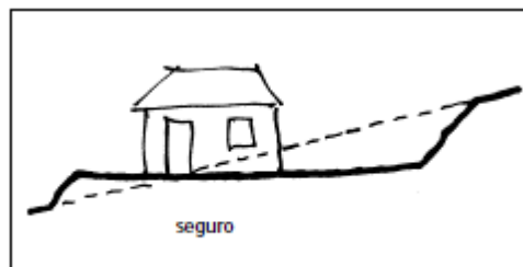
Figura 13 Ubicación de vivienda con corte en terreno (Minke, Manual de Construcción en Tierra, 2005)
