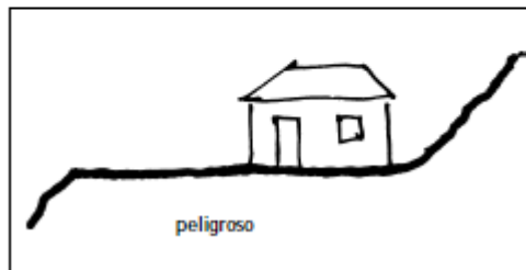
Figura 12 Ubicación de vivienda para evitar deslizamientos (Minke, Lehmbau-Handbuch Manual de Construcción en Tierra, 2005)
