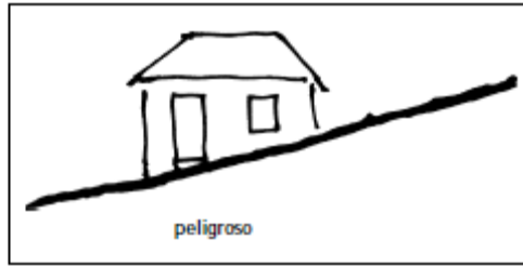
Figura 11 Ubicación peligrosa en pendiente de vivienda. (Minke, Manual de Construcción en Tierra, 2005)
