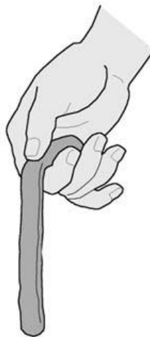
Figura 1 Prueba de cinta de barro Fuente: (ASTM International, 2010)
