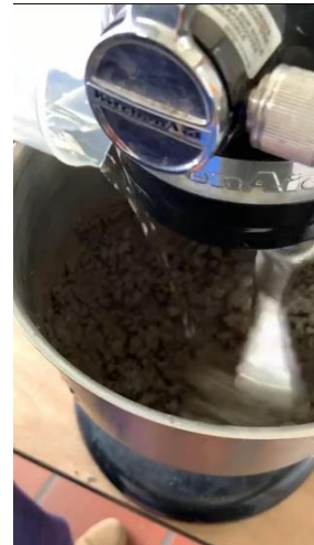
Ilustración 10 agregado de agua a la mezcla
