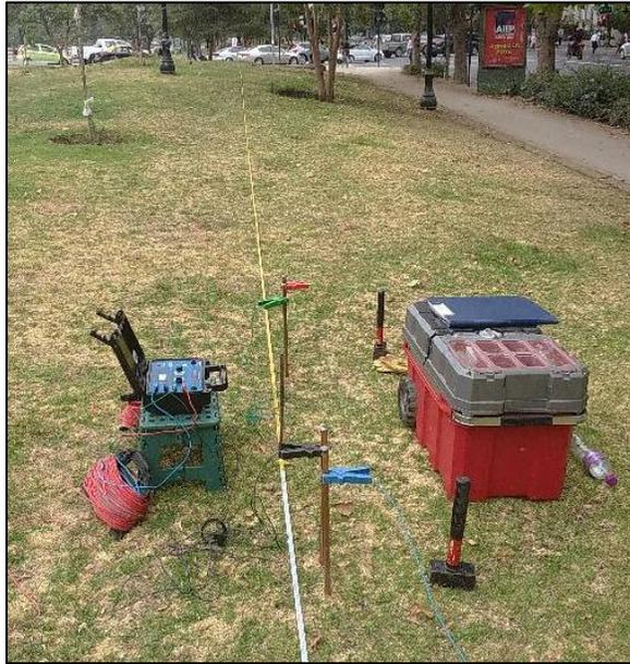
*Figura 2-6 Ejemplo equipo medición resistividad terreno, Fuente: Tomado en línea*
