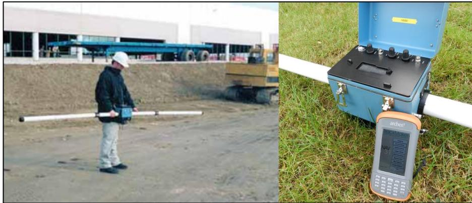
*Figura 2-5 Ejemplo equipo Conductividad del terreno, Fuente: (Geonics Limited, 2013)*
