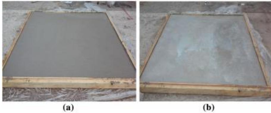
*Ilustración 12. Evaluación de la resistencia a las fisuras en campo. a) después de la colocación y b) después de 56 días.*
