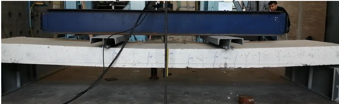
Fotografía E - 8 Fisuras en ciclos 5 y 6
