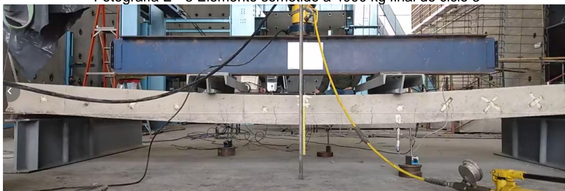
Fotografía E - 3 Elemento sometido a 4000 kg final de ciclo 3
