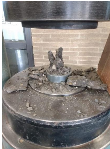
Fotografía B - 18 Carga de falla cilindro fallado elemento LCGFRP-102
