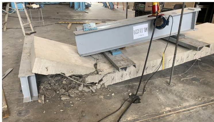
Fotografía No. 11 Falla del elemento LCGFRP-104
