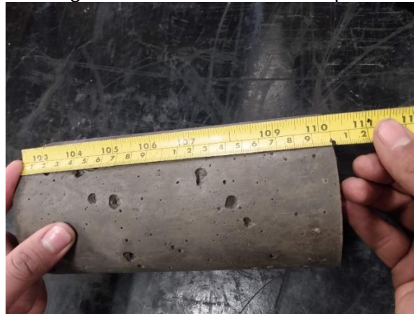
Fotografía B - 2 Cilindro de prueba fallado
