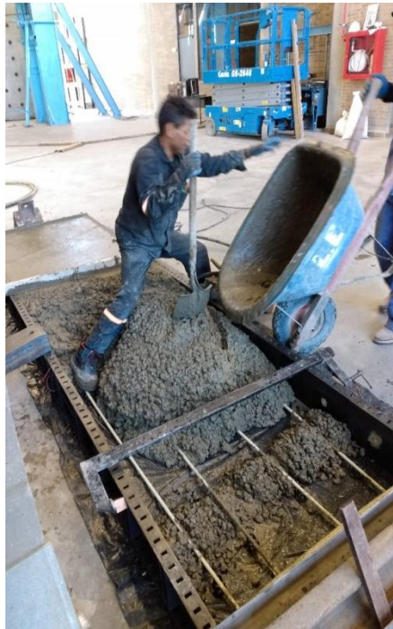
Fotografía B - 12 Proceso de fundida del elemento LCGFRP-102
