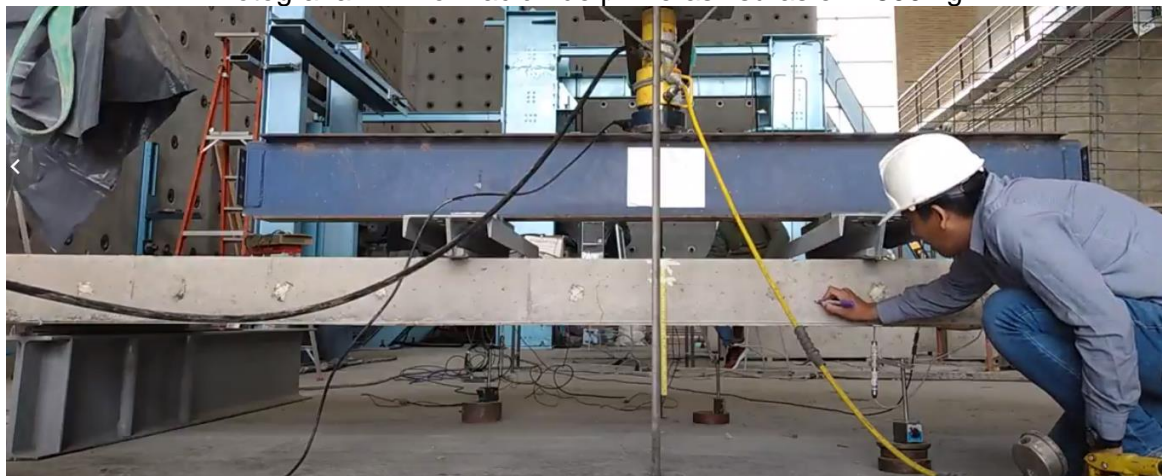
Fotografía E-2 Formación de primeras fisuras en 1800 kg
