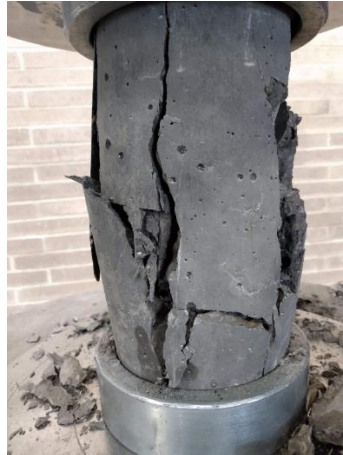
Fotografía B - 17 Cilindro 3 fallado elemento LCGFRP-102
