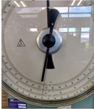
Fotografía B - 4 Carga de falla cilindro 2 de prueba
