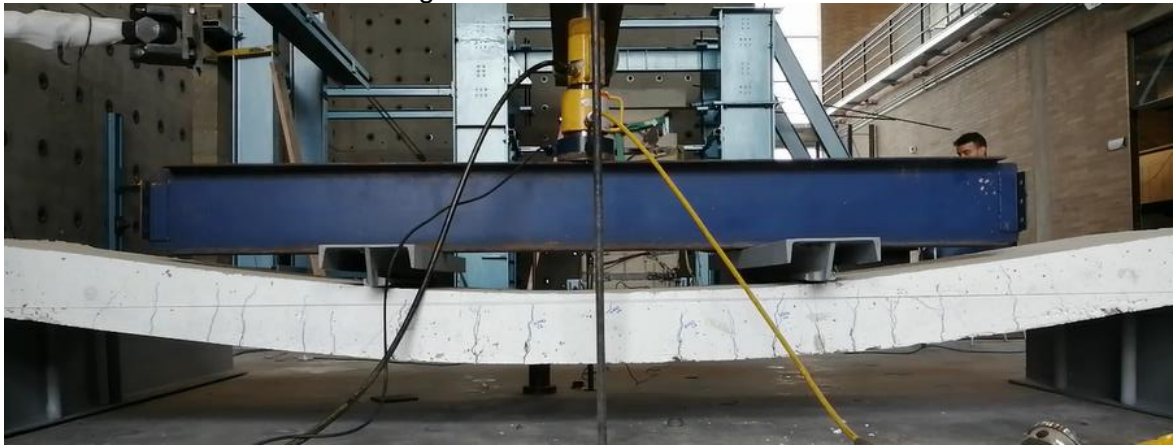
Fotografía E - 10 Fisuras en ciclo 7
