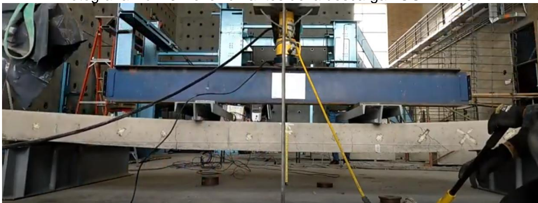
Fotografía No. 14 Deflexión permanente después de la descarga LCGFRP-101
