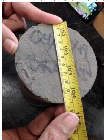
Fotografía B - 1 Diámetro cilindro de prueba
