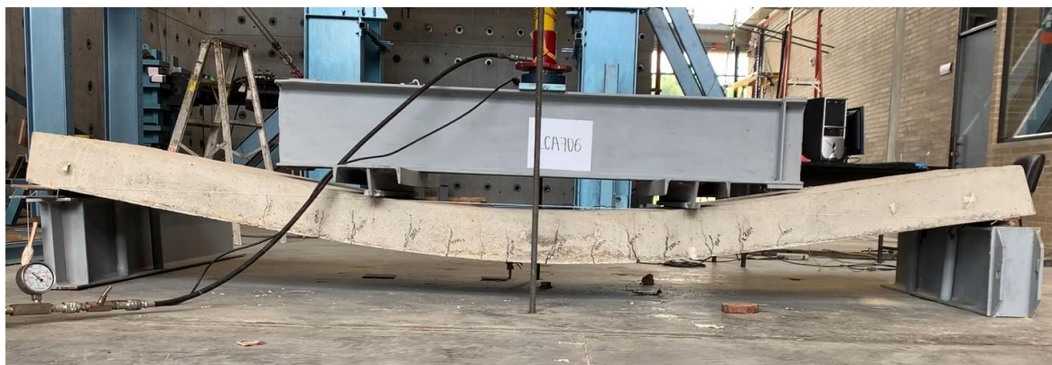
Fotografía No. 15 Deflexión después de la descarga LCGFRP-101
