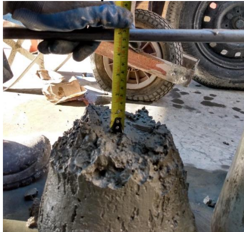
Fotografía B - 10 Ensayo de asentamiento de mezcla
