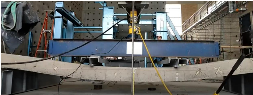
Fotografía No. 13 Deflexión antes de la descarga LCGFRP-101
