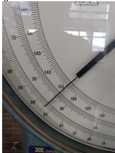
Fotografía B - 18 Carga de falla cilindro fallado elemento LCGFRP-102
