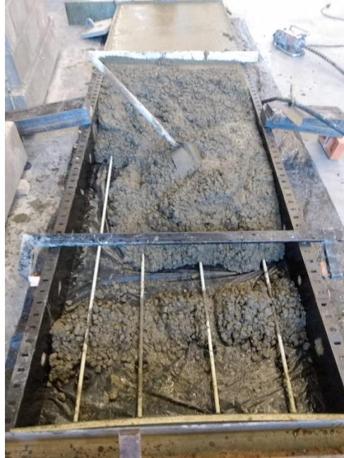
Fotografía B - 12 Proceso de fundida del elemento LCGFRP-102
