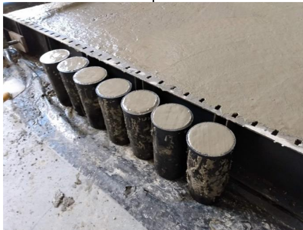
Fotografía B - 14 Cilindros de prueba elemento LCGFRP-102
