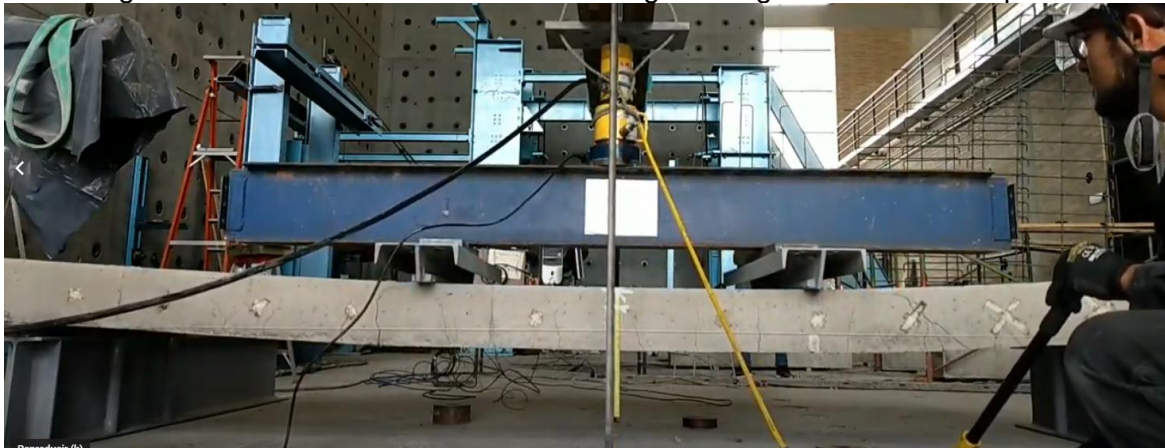
Fotografía E - 6 Elemento sometido a 8000 kg descarga de ciclo 4 - recuperación
