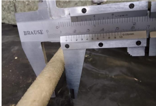
Fotografía B - 6 Diámetro de las barras de GFRP
