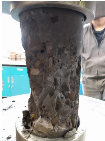
Fotografía B - 3 Carga de falla cilindro 1 de prueba
