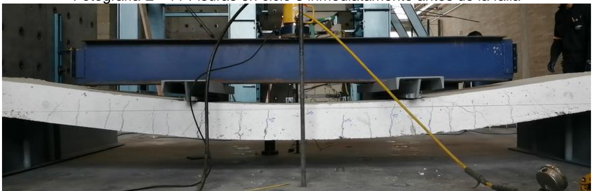
Fotografía E - 11 Fisuras en ciclo 8 inmediatamente antes de la falla
