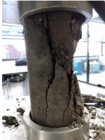
Fotografía B - 15 Cilindro 1 fallado elemento LCGFRP-102
