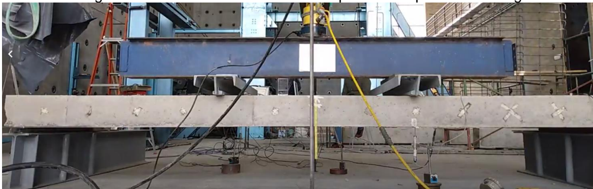
Fotografía E - 1 Elemento acondicionado para iniciar proceso de carga
