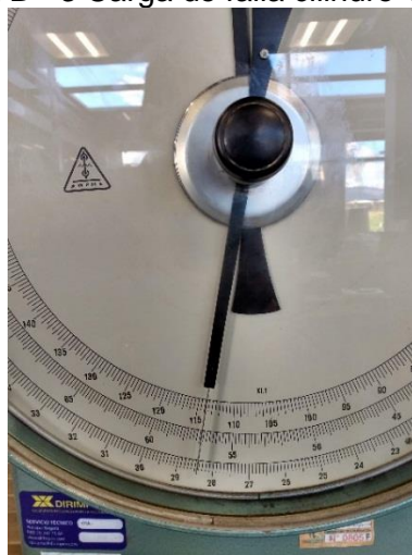
Fotografía B - 3 Carga de falla cilindro 1 de prueba
