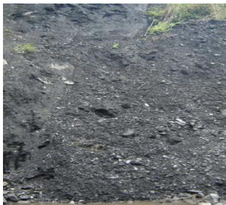
Fotografía 20 Suelo residual clase 3, derivado de rocas blandas clase 1 (Fm. Trincheras). Fuente (SGC, 2009).
