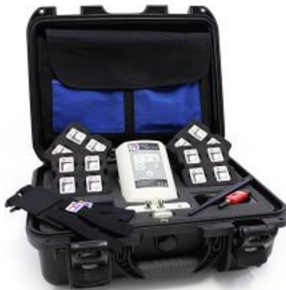
Figura 2.2. Sistema Tech MCS. Dispositivo para captura de movimiento con 16 sensores comunicados por protocolo CAN bus (TechNaid, 2019).
