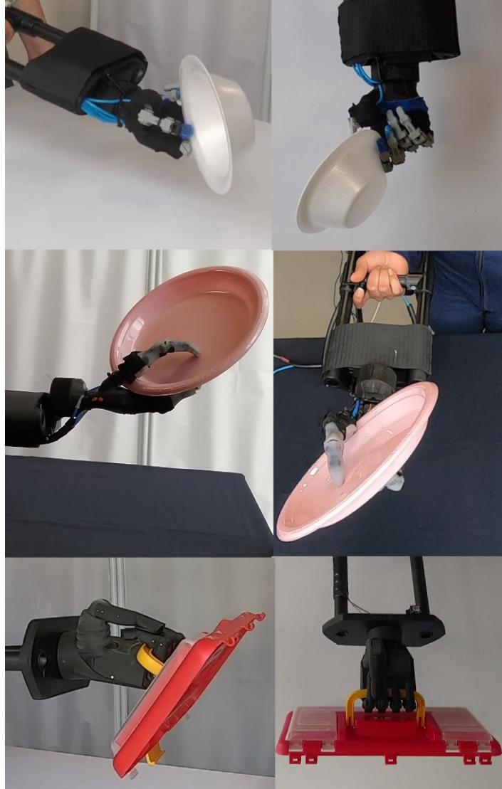
Figura 4.11: Ejemplos de algunos objetos usados para la prueba funcional AHAP. De arriba hacia abajo, la primera prótesis es PrExHand A, la segunda PrExHand B y la tercera la prótesis de Prótesis Avanzadas.
