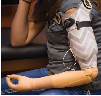
Figura 2.6: Prótesis accionada eléctricamente, el ejemplo muestra una controlada por señales de EMG [21].
