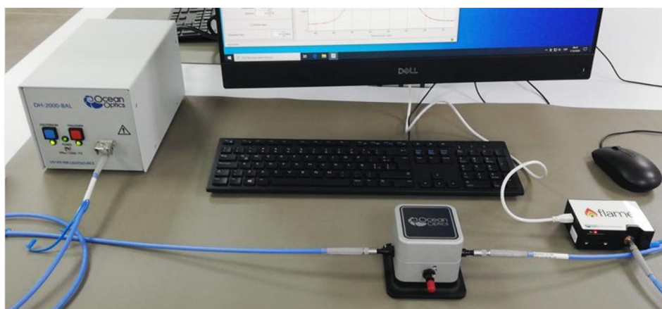
Figura 3.3: Montaje espectrofotómetro FLAMES-S-XR1-ES - Ocean view.
