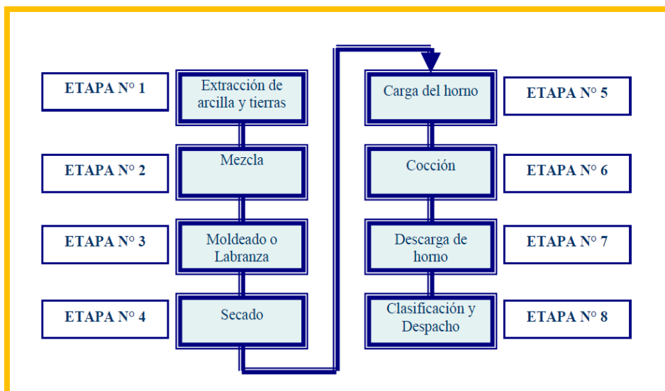
Figura 4. Estructura de las etapas de la actividad (fabricación de bloque)
