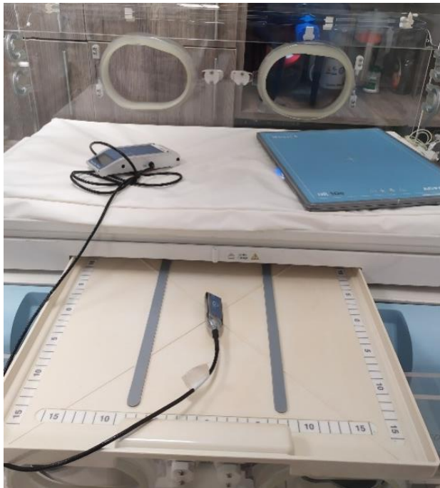
Figura 10: Dosímetro ubicado dentro del porta-chasis.
