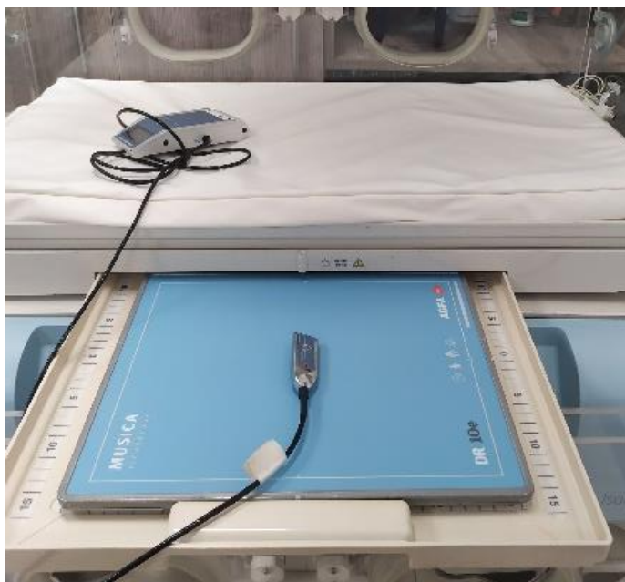
Figura 6: Dosímetro ubicado centrado sobre el detector para el disparo libre.
