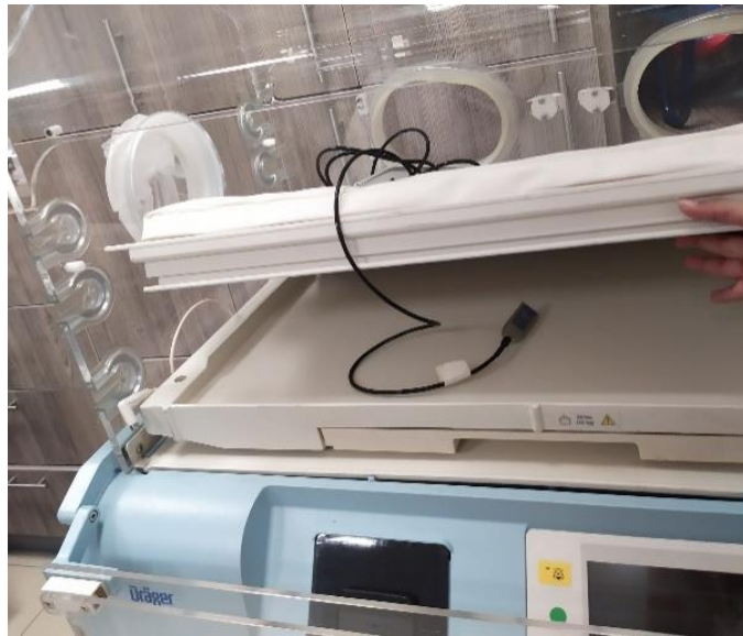
Figura 9: Dosímetro ubicado bajo la bandeja, sobre la superficie del porta-chasis.
