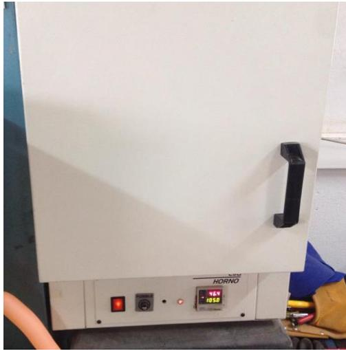
**Ilustración 13** Horno Utilizado para pruebas de medición de porcentaje de humedad.
