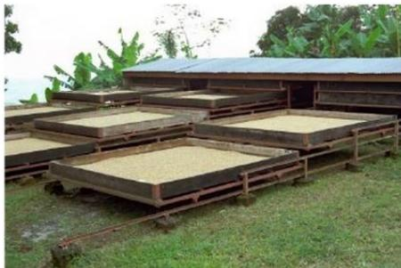
**Ilustración 5** Secado en carros o silos
