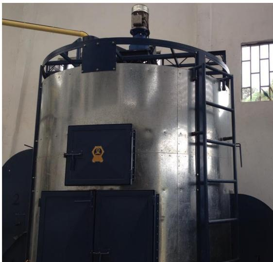
**Ilustración 18** Silo-secador de CENICAFÉ utilizado en la Finca La Primavera.
