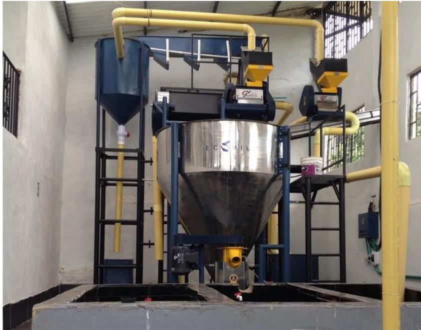
**Ilustración 16** Tanque de fermentación de la Finca La Primavera.
