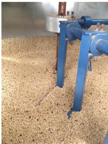
**Ilustración 19** Silo secador.
