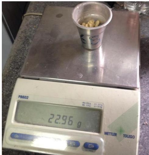
**Ilustración 14** Balanza analítica.
