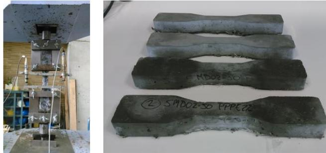
ILUSTRACIÓN 2. – CUERPO DE PRUEBA “DOGBONE” Y ENSAYO A TRACCIÓN DIRECTA CONFORME A JSCE-08 [30,40,42].
