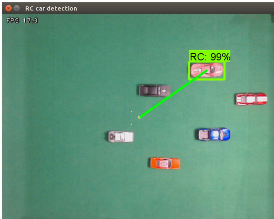
Figura 5.6: Representación de detección del carro de radio control. Imagen de salida del detector de objetos con el rendimiento FPS y porcentaje de precisión.
