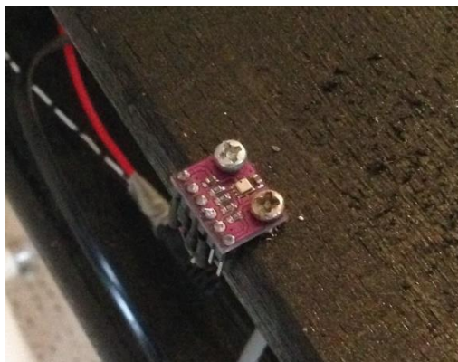
Figura 29. Sensor de humedad instalado
