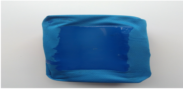
(a) Interfaz cubierta por tela deportiva que a su vez está cubierta por la Silicona Dragon Skin TM .
