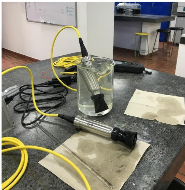
Fotografía 5. Calibración de las sondas en el laboratorio. Fuente: elaboración propia
