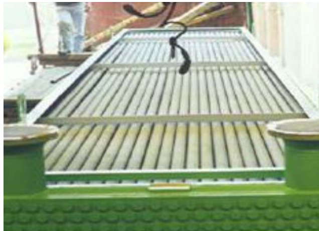
Foto 1.5 Tubos aleteados y serpentines, fabricado en las instalaciones de Colsering S.A.S
