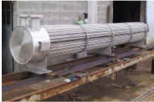
Foto 1.3 Intercambiador de calor fabricado en las instalaciones de Colsering S.A.S.
