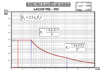
**Ilustración 18: Espectro elástico de diseño.**
