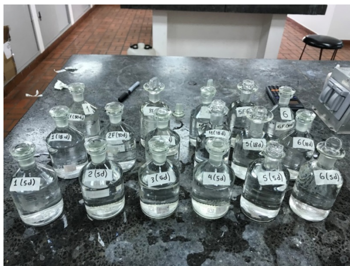
Foto 5-10 Botellas de Winkler para incubación. Fuente: elaboración propia
