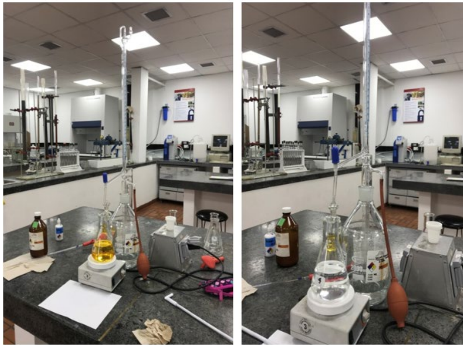
Foto 5-8 Titulación del oxígeno disuelto. Fuente: elaboración propia
