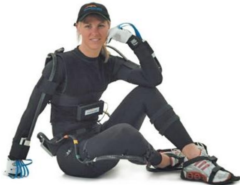
Figura 2. Traje de captura por fibra óptica, shapewrap III de Measurand [8]
