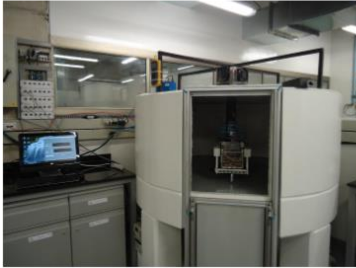
Ilustración 22. Centrifuga geotécnica. (Tomado de: Mecánica de suelos aplicada – MSUA – Cimentaciones superficiales, MS.c. Lina Ximena Garzón Avila.).
