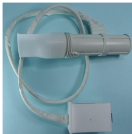
Figure E.1: Sensor de flujo y transductor a señal eléctrica.
