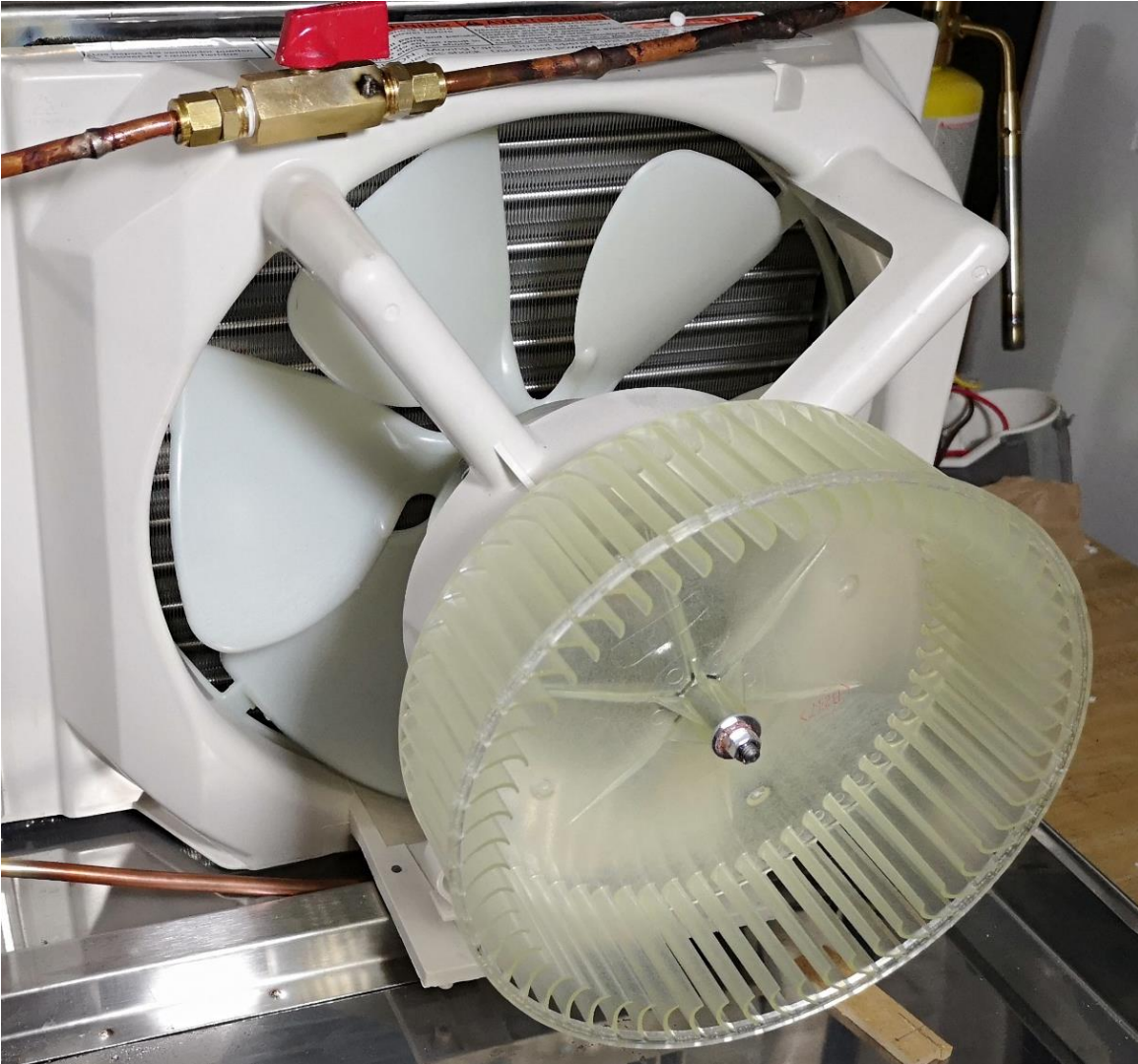
Ilustración 30. Ventilador axial y ventilador centrífugo del Condensador
