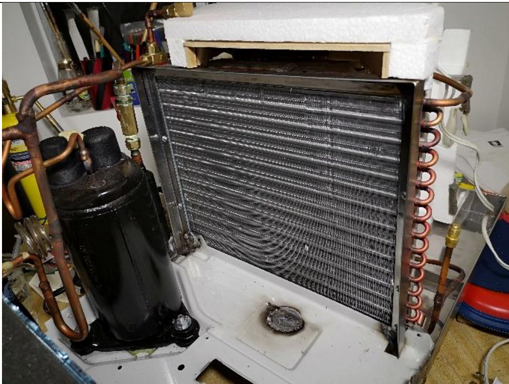
Ilustración 39. Modelación del túnel de viento – Serpentín del condensador desnudo – Zona de la banda absorbente
