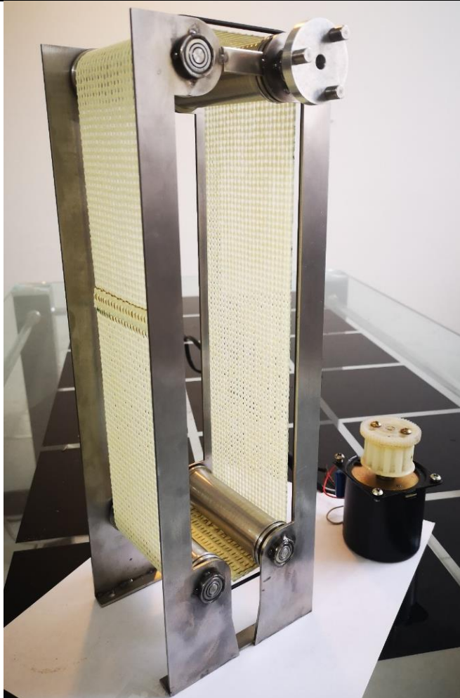
Ilustración 51. Proceso de construcción del conjunto Banda absorbente – Chasis de la banda en acero inoxidable – Sistema de tracción tipo araña en aluminio
