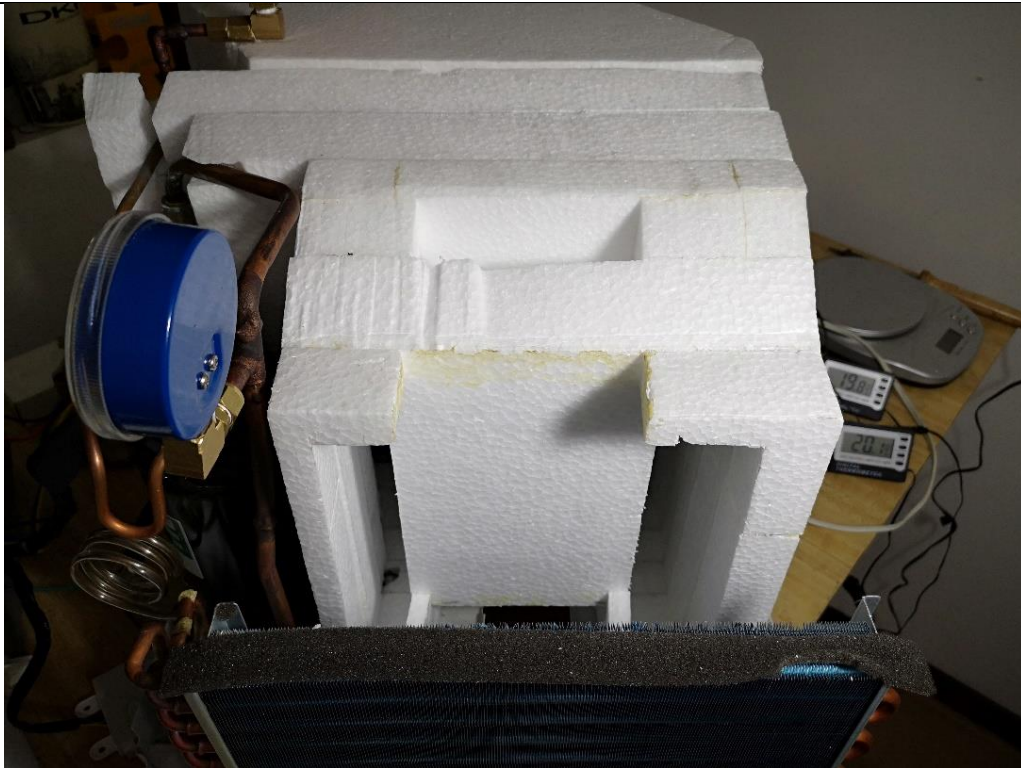
Ilustración 41. Modelación del túnel de viento con poliestireno expandido (EPS) – Zona de la banda absorbente, segundo tramo
