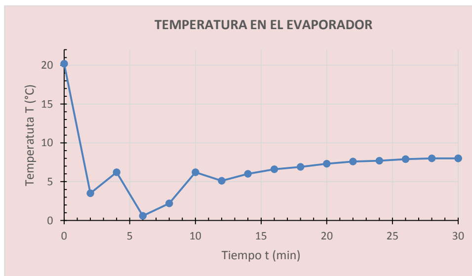
Ilustración 78 - Temperatura del aire en la unidad evaporadora - Segunda prueba
