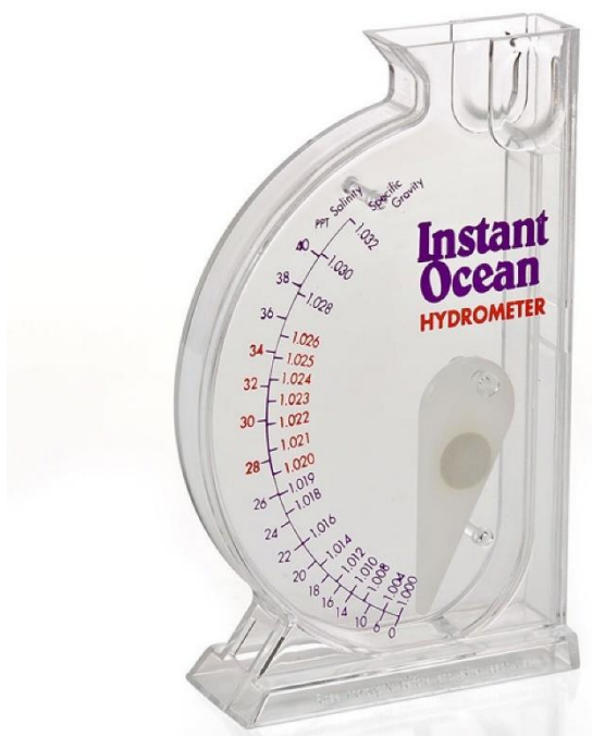
Ilustración 46. Hidrómetro para medir salinidad del agua influente
