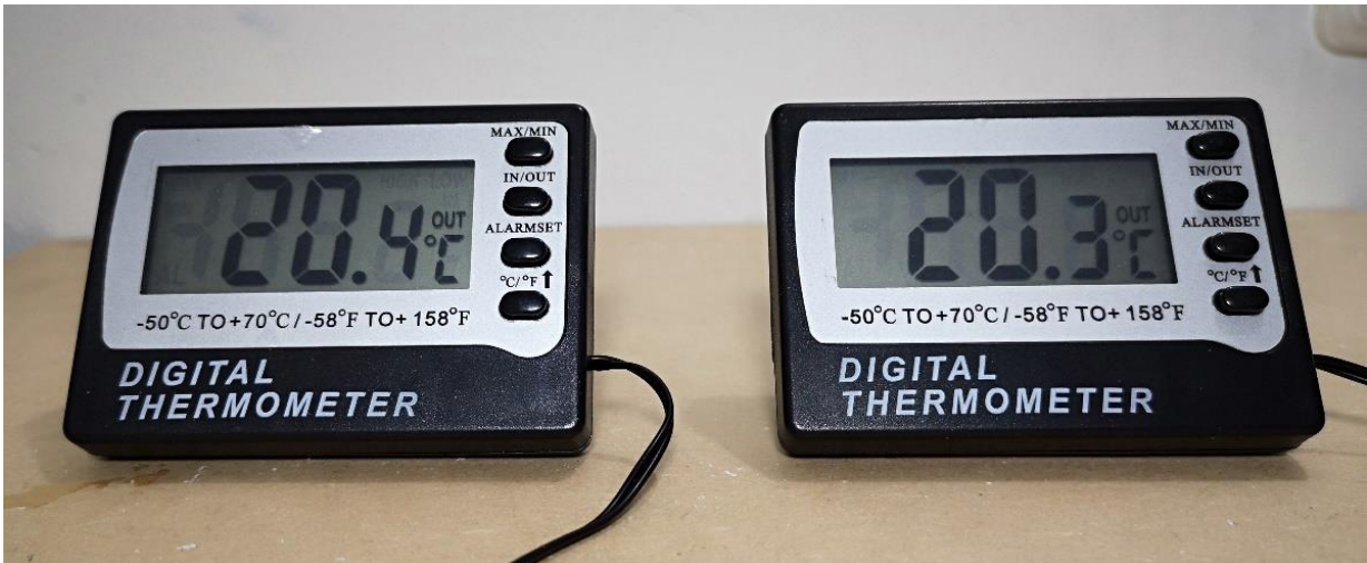
Ilustración 69. Termómetros digitales para control de temperatura en la Unidad Condensadora y en la Unidad Evaporadora
