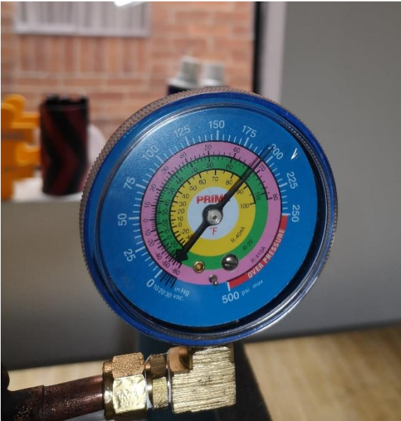
Ilustración 68. Manómetro para línea de gas de baja presión
