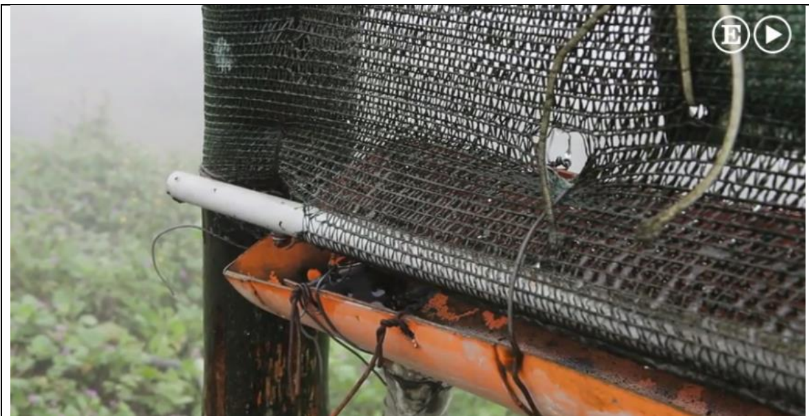
Ilustración 15. Atrapa niebla y canaleta de recolección
