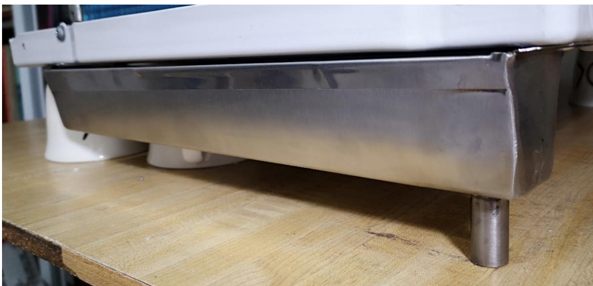
Ilustración 66. Canaleta de recolección de agua tratada
