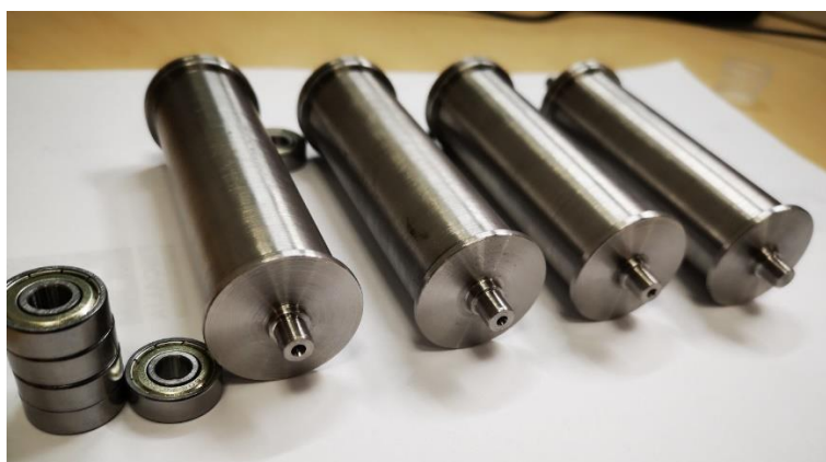
Ilustración 50. Proceso de construcción del conjunto Banda absorbente – Cilindros giratorios y rodamientos de bolas en acero inoxidable
