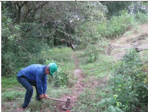
Extremo línea sísmica 5 margen derecha río, se observa martillo y platina utilizado como fuente de energía.
