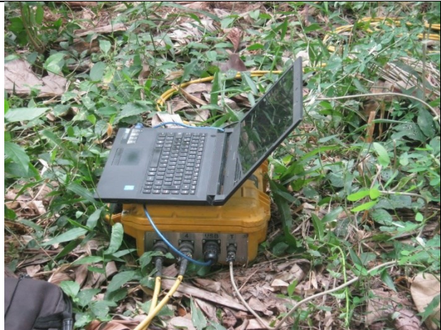
Equipo de adquisición localizado en la parte central de la línea sísmica 1.
