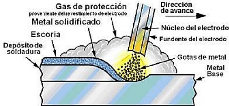
Figura 4-89. Proceso de soldadura por arco eléctrico con electrodo revestido.
