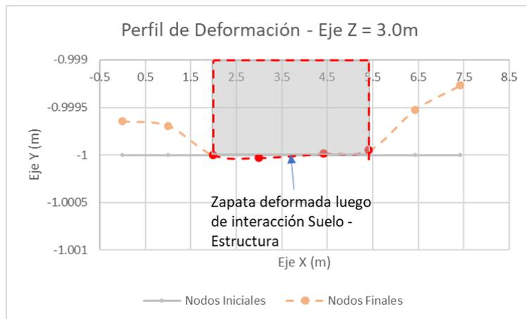
Figura 23 Perfil de deformación bajo la zapata – Modelo 3
