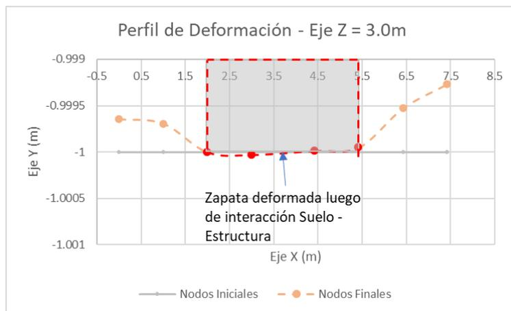
Figura 34 Perfil de deformación bajo la zapata – Modelo 3
