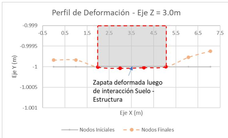
Figura 23 Perfil de deformación bajo la zapata – Modelo 1
