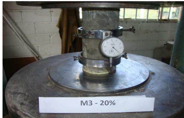
Figura 30 Ensayo resistencia a la compresión.
