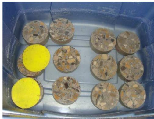
Figura 38 Pre-acondicionamiento de la muestra.
