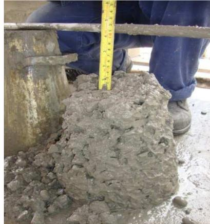
Figura 28 Medición de asentamiento en muestras.
