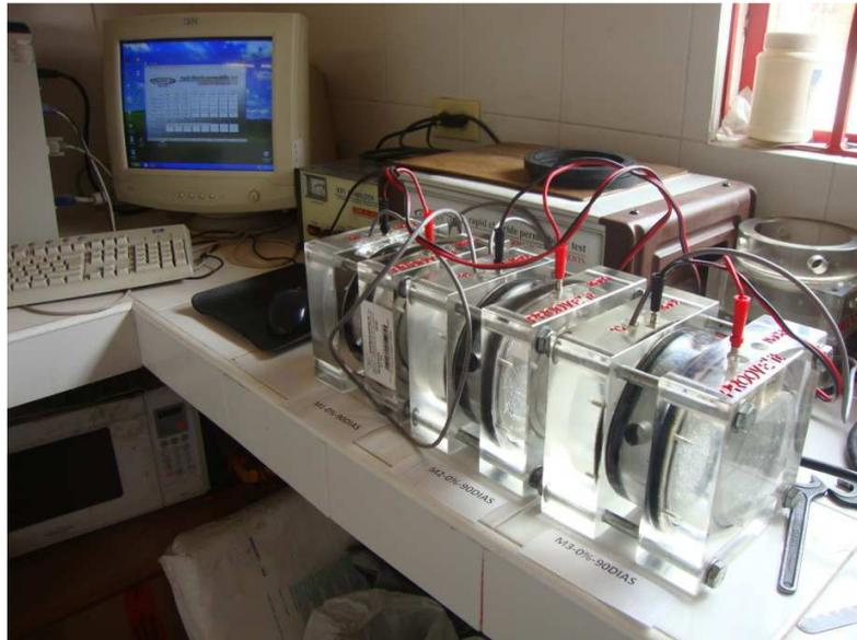
Figura 5 Ensayo de resistencia a la penetración de cloruros RCPT.
