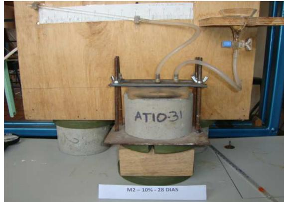
**Figura 32 Ensayo de absorción ISAT.**
