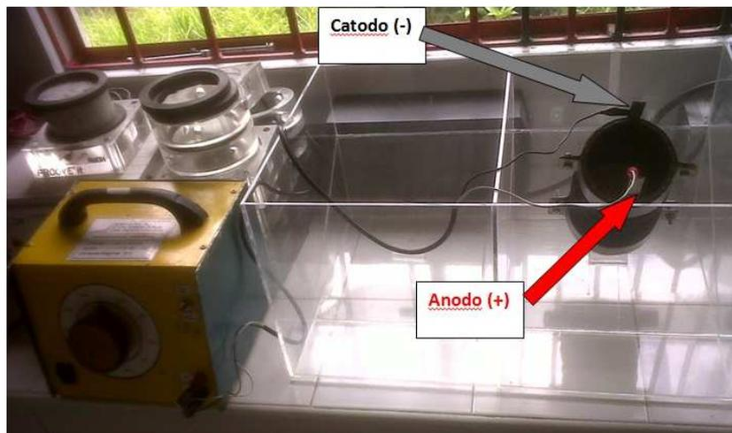
**Figura 35 Conexión de ánodo y cátodo en espécimen de ensayo.**
