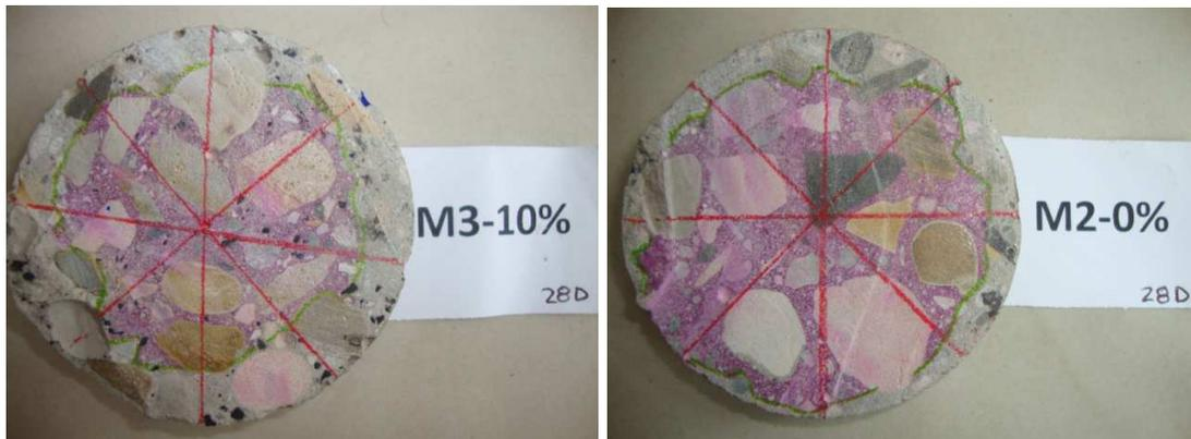
Figura 37 Penetración frente de carbonatación.
