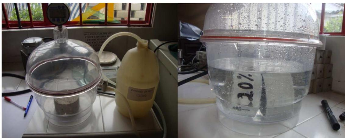
**Figura 34 Pre-acondicionamiento de muestras NTBUILD-492.**
