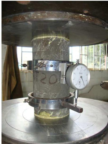
Figura 3 Ensayo de resistencia a la compresión.
