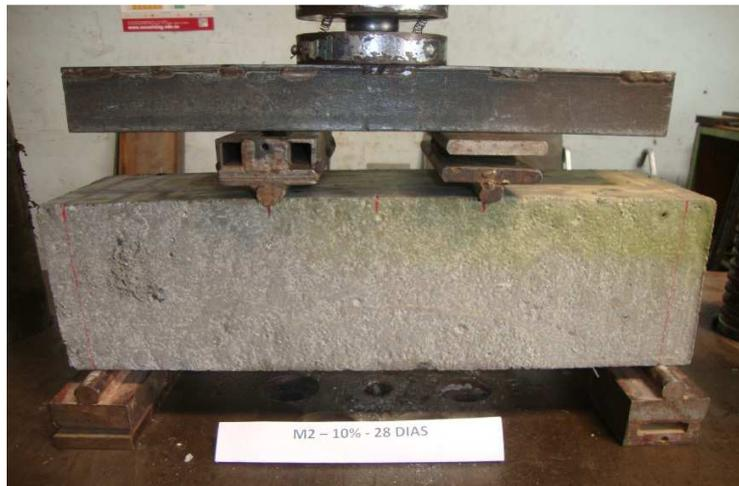
**Figura 4 Ensayo de resistencia a flexión.**
