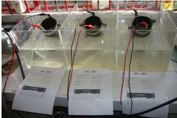
Figura 36 Ensayo de penetración de cloruros NT BUILD492.
