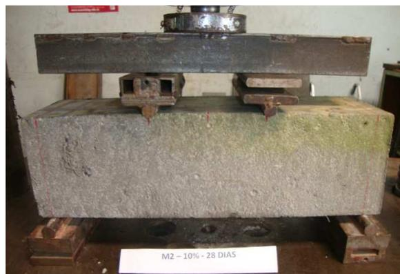
Figura 31 Ensayo resistencia a la flexión.
