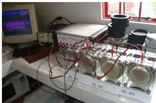
**Figura 33 Ensayo de absorción ISAT.**
