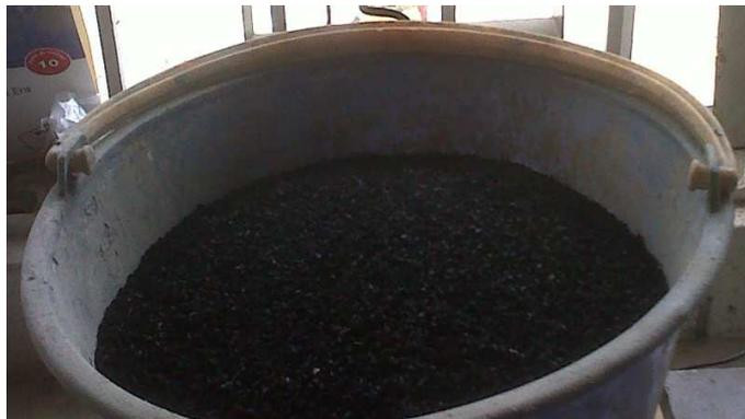
**Figura 27 Caucho granulado proveniente de llantas en desuso.**
