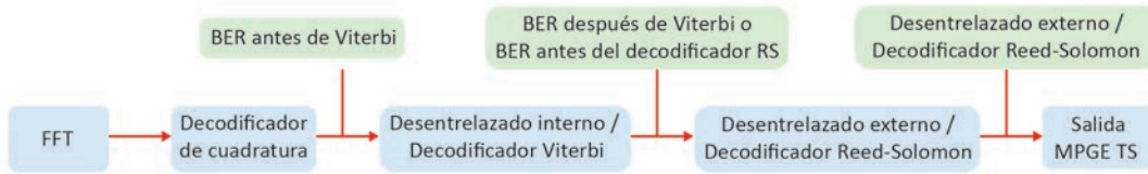
Figura 5. Diagrama simplificado de un receptor DVB-T. Fuente: (R&S, 2012).
