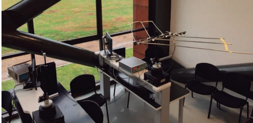
Figura 122. Sistema de mediciones del patrón de radiación y ganancia de antena.
