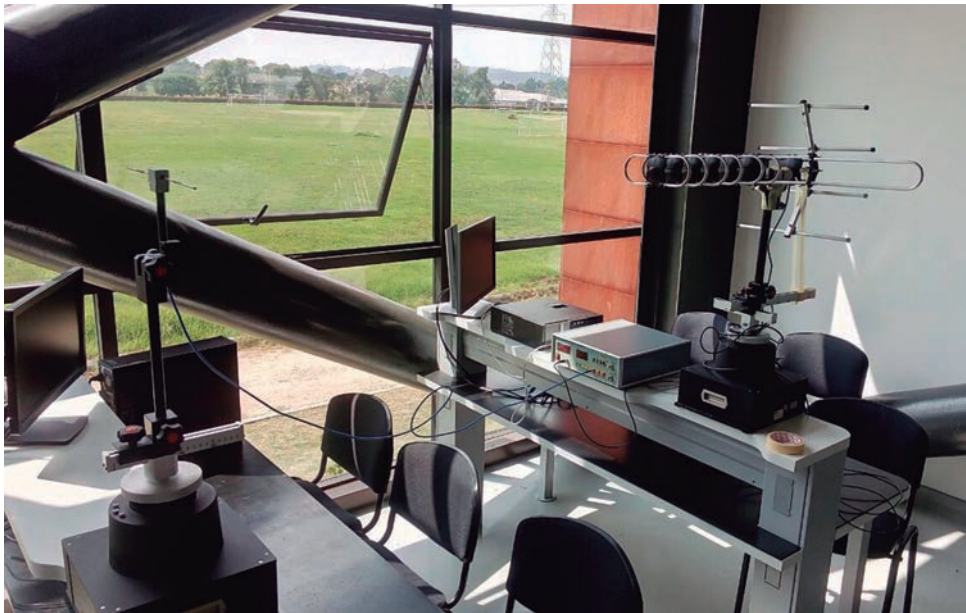
Figura 128. Organización del sistema de mediciones del patrón de radiación y ganancia de antena.
