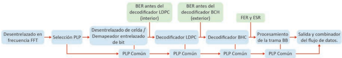
Figura 6. Diagrama simplificado de un receptor DVB-T2. Fuente: (R&S, 2012).
