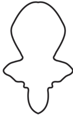
Figura 123. Patrón simulado de antena Yagi-Uda.
