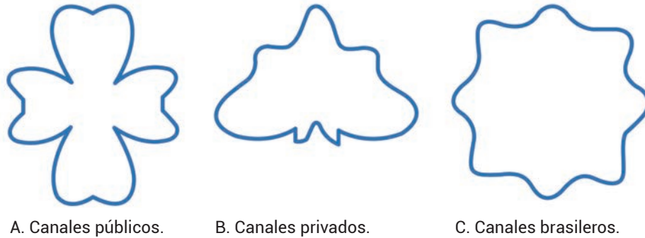
Figura 120. Patrón de radiación de la antena de transmisoras con azimut 0°.
