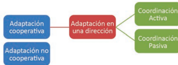
Figura 139. Tipos de adaptación en sistemas cognitivos basados en IEEE 1900.2.
