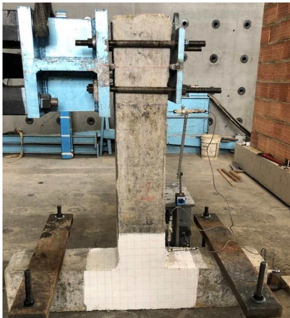
Ilustración 6 Conexión Viga-Columna. Fuente propia
