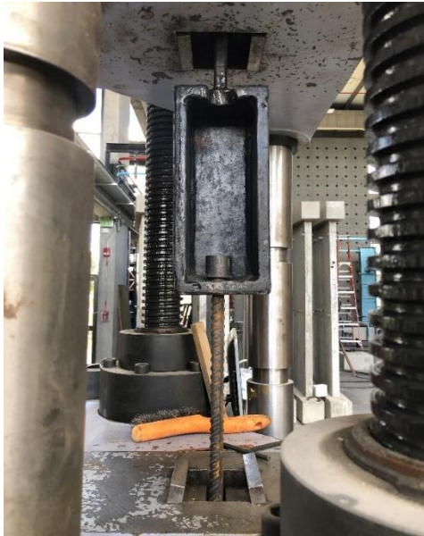
Ilustración 3 Montaje ensayo a tracción. Elaboración propia
