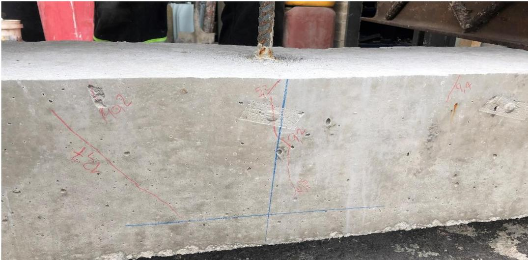
*Ilustración 85 Falla barra #6 ensayo adicional. Fuente propia*
