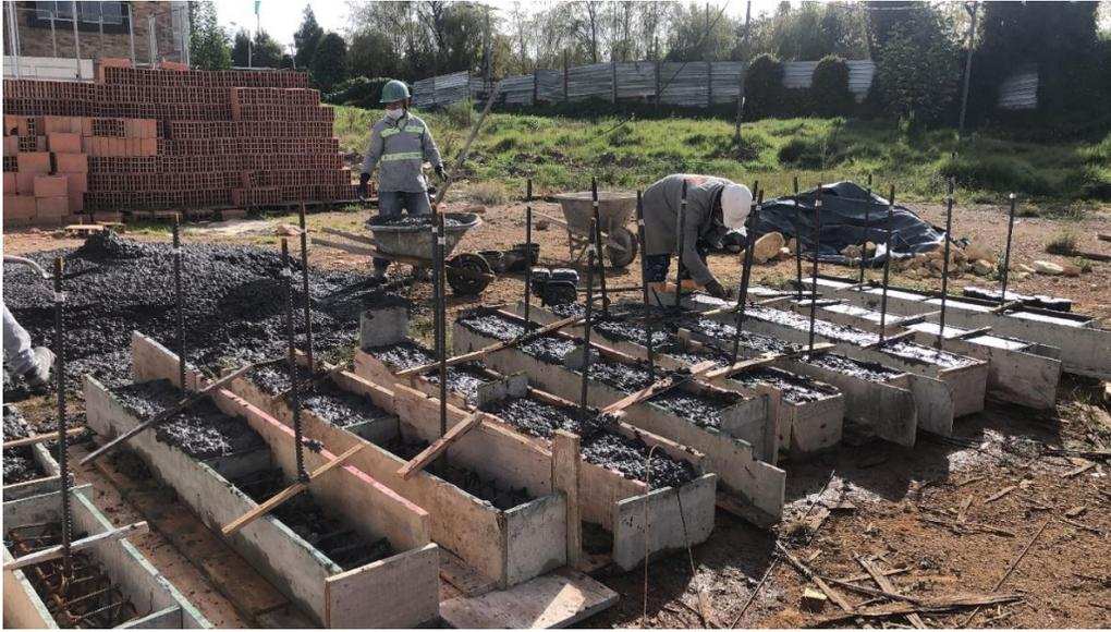
*Ilustración 37 Fundida de especímenes para ensayo de extracción. Fuente propia*
