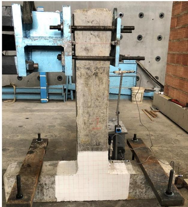
*Ilustración 92 Conexión Viga-Columna #1. Fuente propia*
