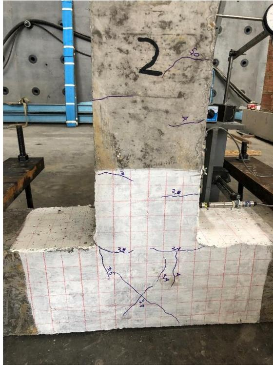
*Ilustración 93 Conexión Viga-Columna #2. Fuente propia*
