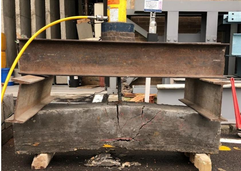
*Tabla 15 Ensayo de extracción. Barra # 6 profundidad 18 cm. Fuente propia*
