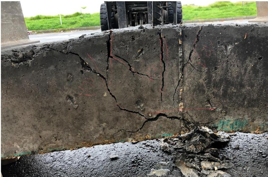
*Ilustración 74 Falla flexión barra #6 (b). Fuente propia*
