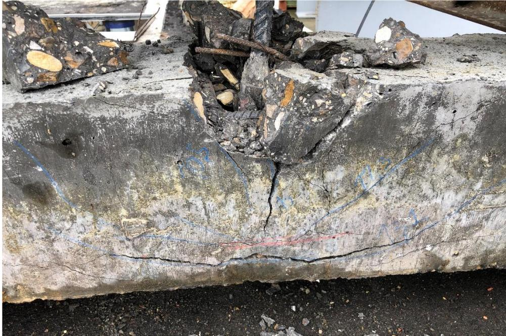
*Ilustración 57 Cono de falla Muestra #5. Barra # 6 profundidad 13 cm. Fuente propia*
