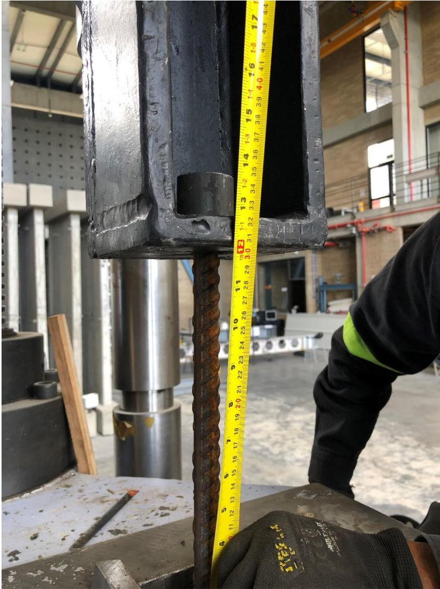
*Ilustración 48 Ensayo de tensión directa barra #6. Fuente propia*
