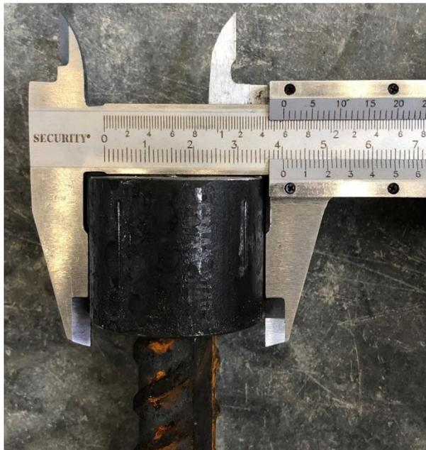
*Ilustración 45 Verificación medida cabeza barra #6 geometría circular. Fuente propia*
