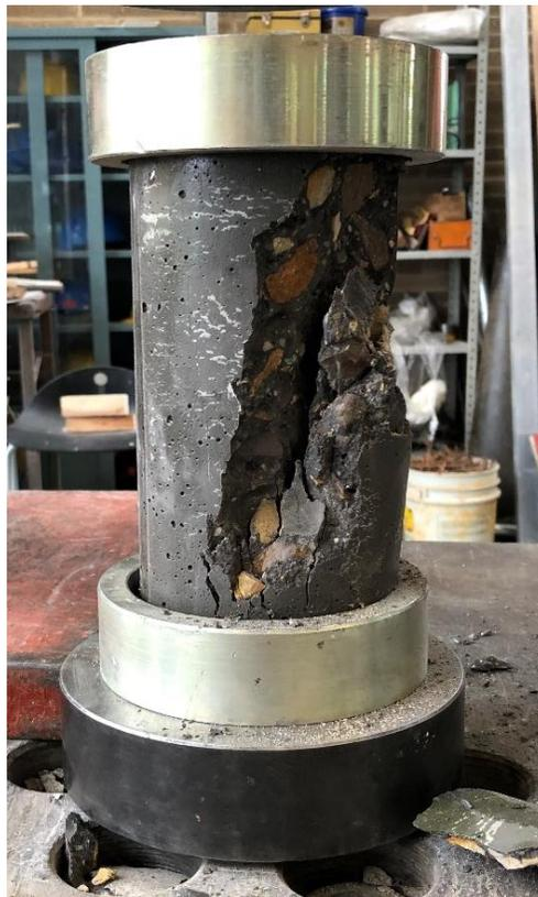
*Ilustración 31 Falla a compresión cilindro de concreto. Día # 32 después de fundida. Fuente propia*
