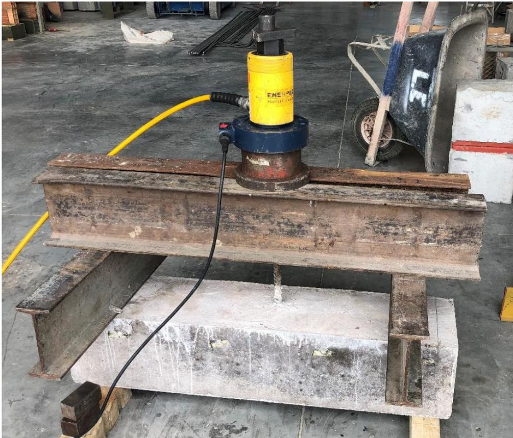
*Ilustración 40 Montaje ensayos de extracción, Fuente propia*
