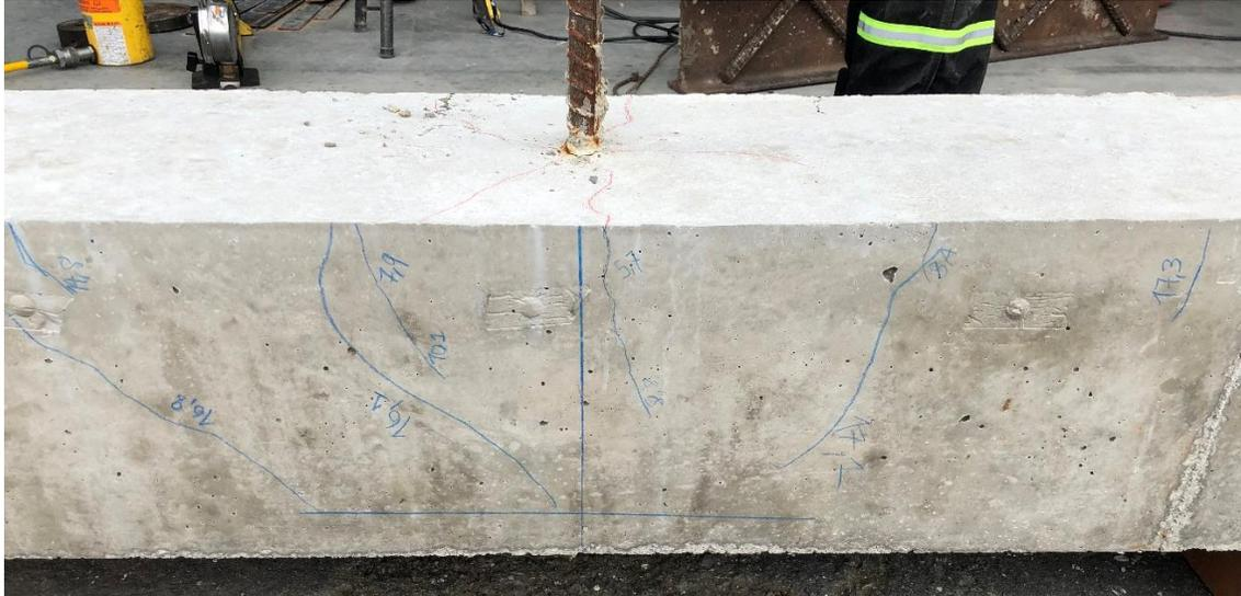
*Ilustración 90 Falla barra #7 ensayo adicional. Fuente propia*
