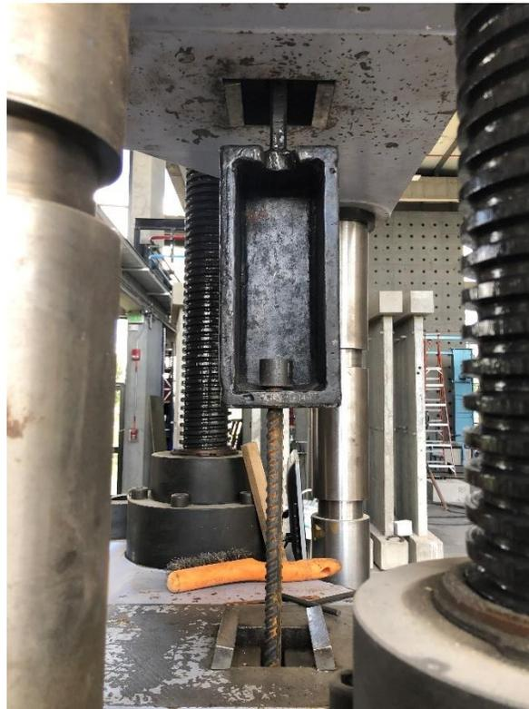
*Ilustración 6 Montaje experimental. Ensayo a tracción. Fuente propia*
