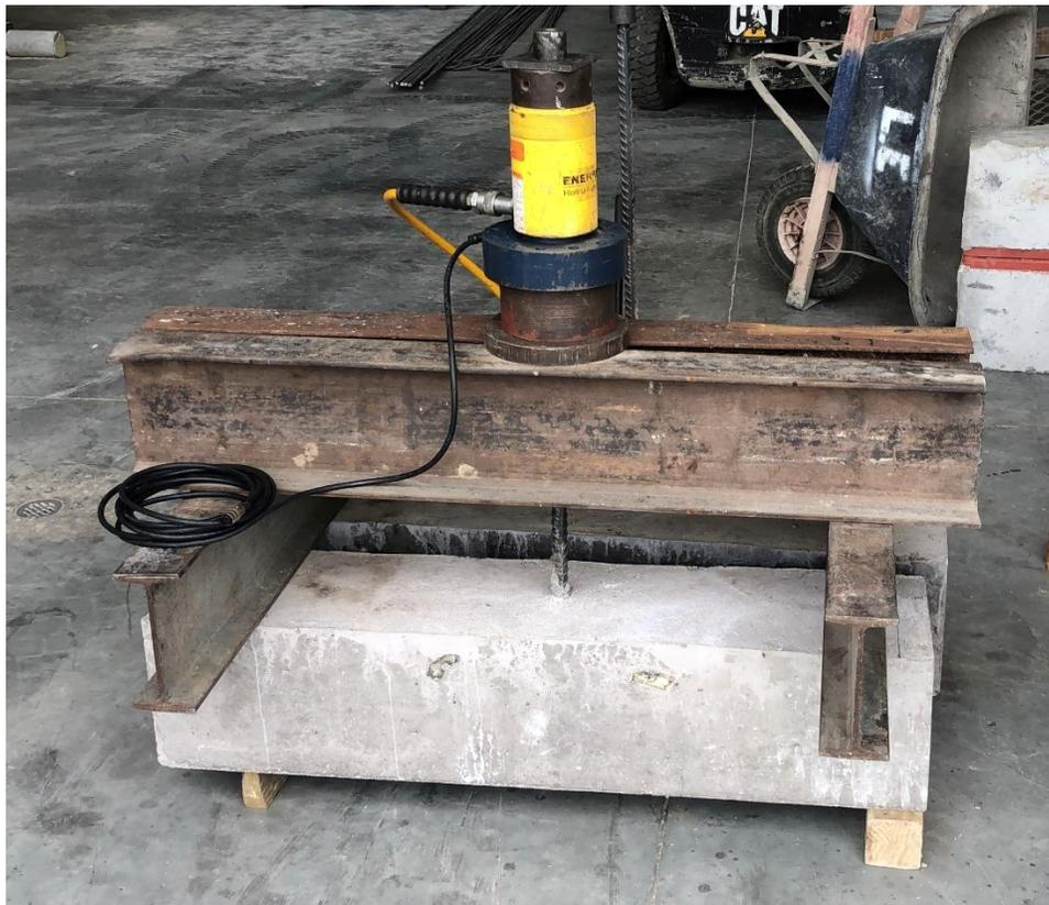
*Ilustración 8 Montaje. Ensayo de extracción. Fuente propia*
