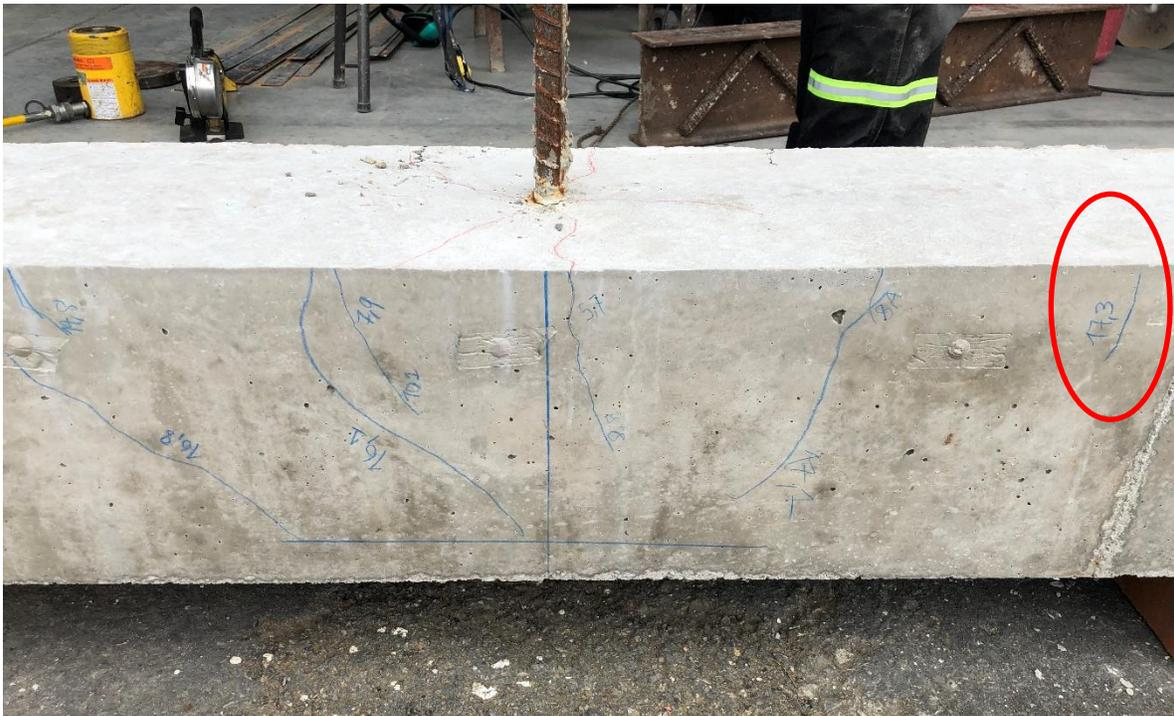
*Ilustración 88 Fisuras espécimen adicional barra #7. Fuente propia*
