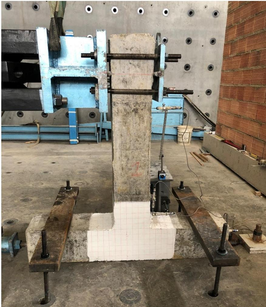
*Ilustración 41 Montaje ensayo conexión viga-columna. Fuente propia*
