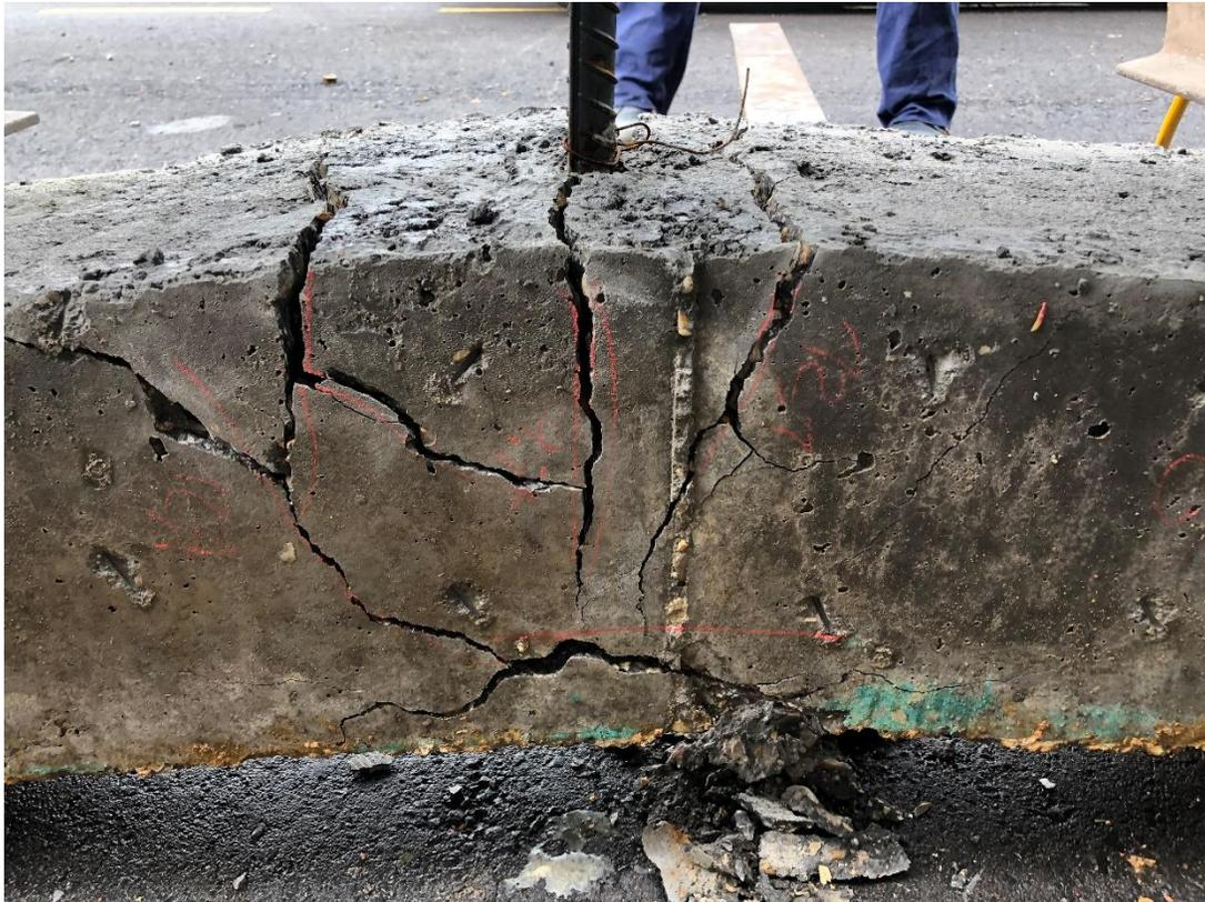
*Ilustración 76 Falla flexión barra #7 (b). Fuente propia*
