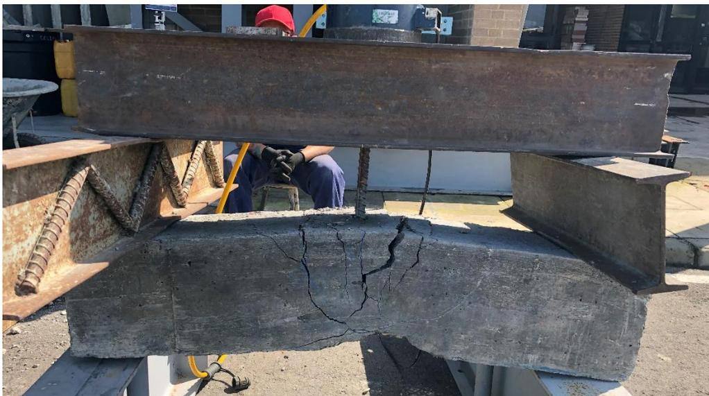
*Ilustración 66 Falla a flexión en espécimen barra #6. Fuente propia*
