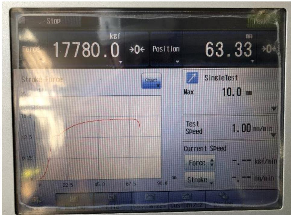
*Ilustración 35 Carga aplicada varilla #6. Fuente propia*
