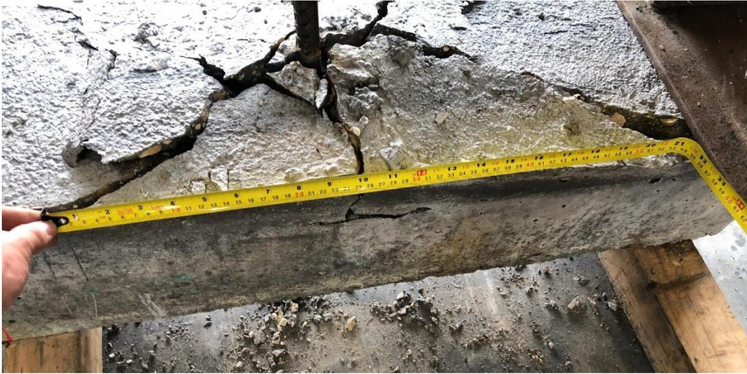
*Ilustración 67 Medición cono de falla. Fuente propia*
