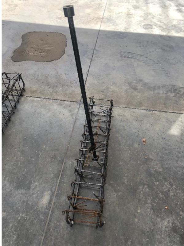
*Ilustración 38* Espécimen con refuerzo y barra con cabeza. Fuente propia
