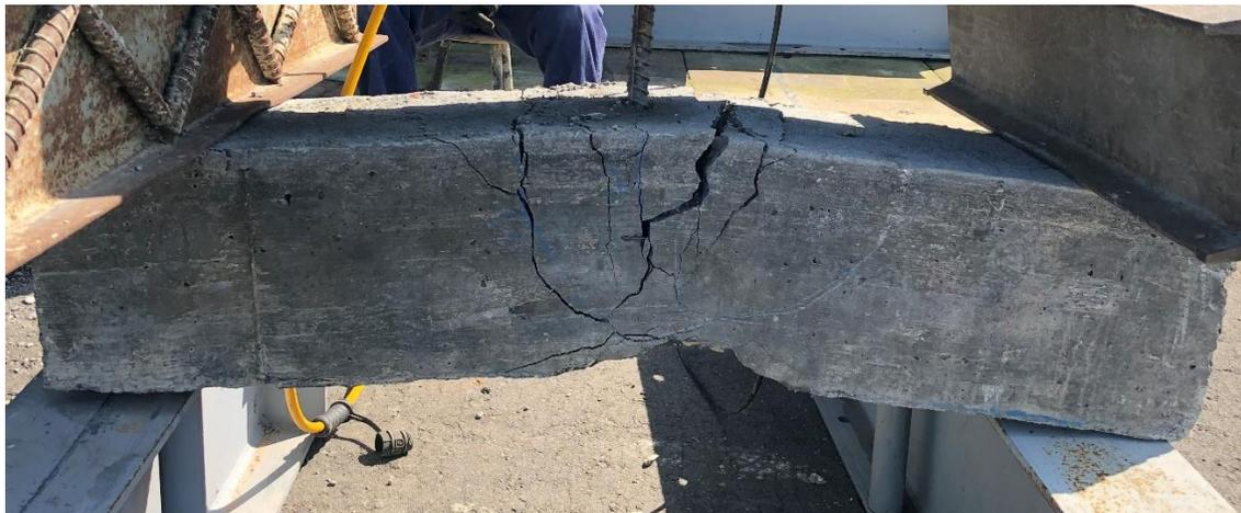
*Ilustración 91 Falla barra #7 ensayo inicial. Fuente propia*
