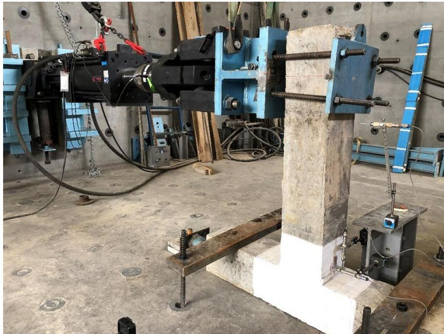
*Ilustración 10 Montaje. Ensayo de carga cíclica. Elaboración propia*
