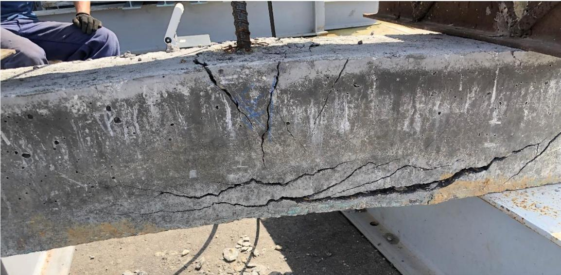
*Ilustración 61 Cono de falla Muestra #5. Barra # 6 profundidad 18 cm. Fuente propia*
