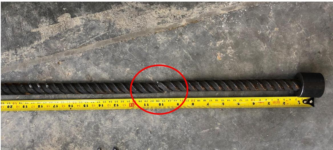
*Ilustración 51 Falla a tensión en barra mediante ensayo de tensión directa. Fuente propia*
