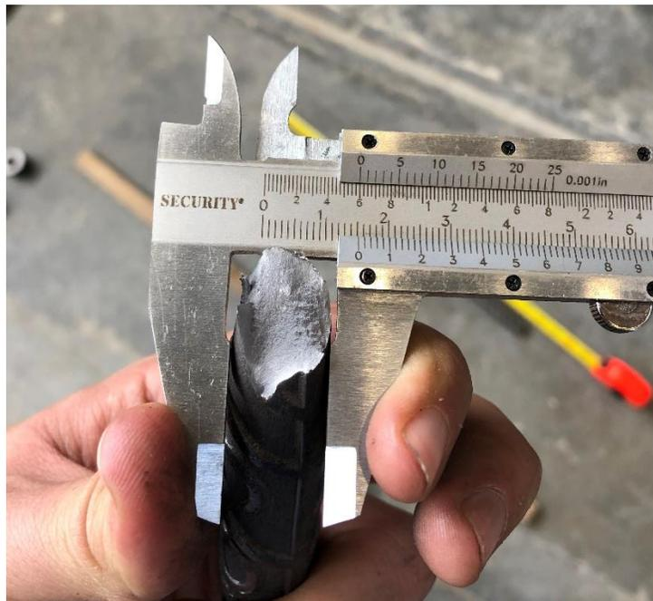
*Ilustración 36 Medición diámetro después de ruptura de la barra. Fuente propia*
