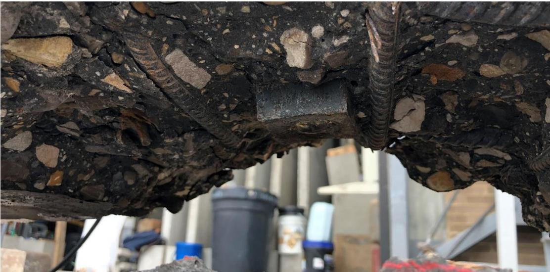
*Ilustración 64 Falla inferior recubrimiento. Barra # 7 profundidad 22.4 cm. Fuente propia*
