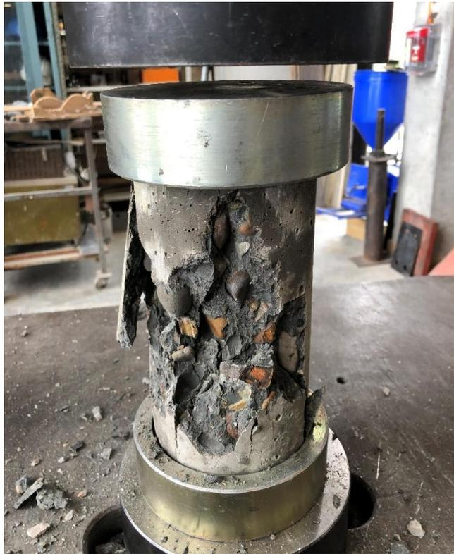
*Ilustración 79 Falla a compresión cilindro pruebas adicionales. Fuente propia*
