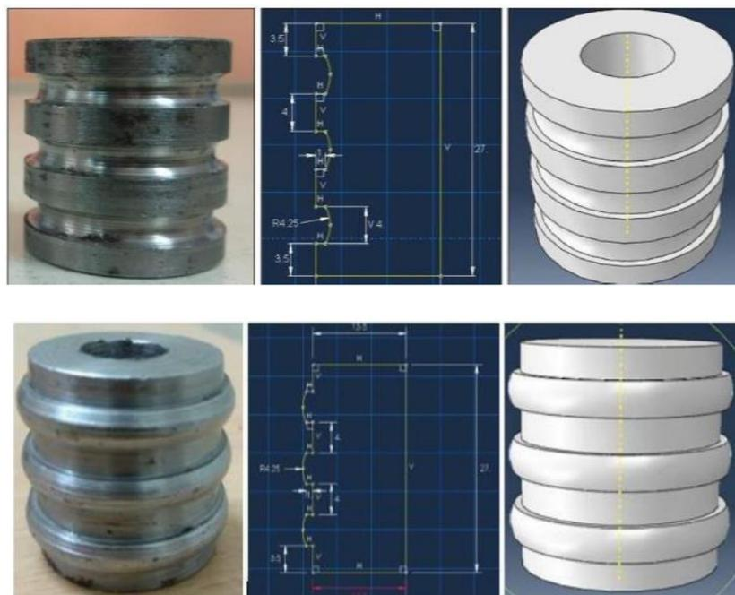
*Ilustración 28 Cabeza acanalado interno y externo. Shubham (2021)*
