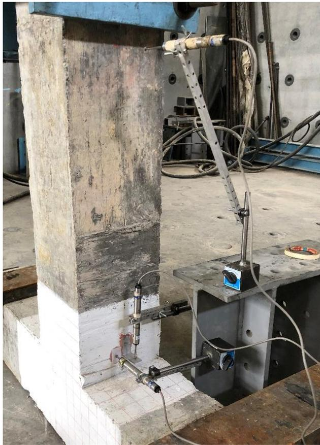
*Ilustración 70 Transductores LVDTs conexión viga columna. Fuente propia*
