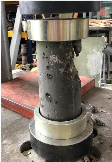
*Ilustración 32 Falla a compresión cilindro de concreto. Día # 36 después de fundida. Fuente propia*
