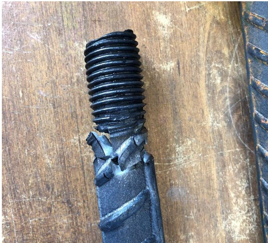
*Ilustración 55 Falla a tensión cercana a la conexión. Fuente propia*
