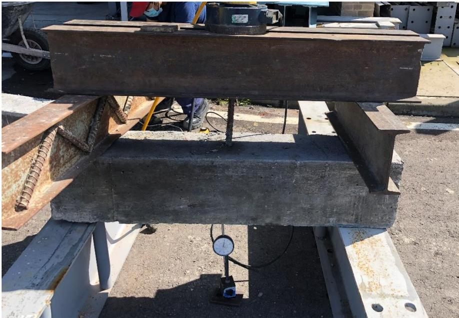
*Ilustración 65 Espécimen barra #6 con deformímetro. Fuente propia*
