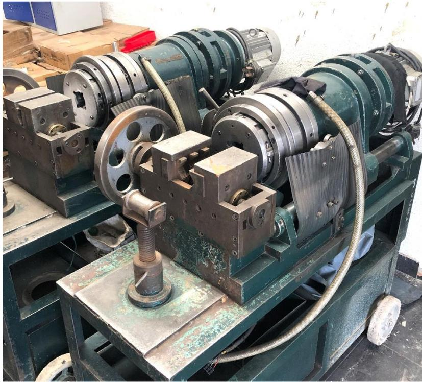
*Ilustración 46 Maquinaria de roscado. Ramalza s.a.s*
