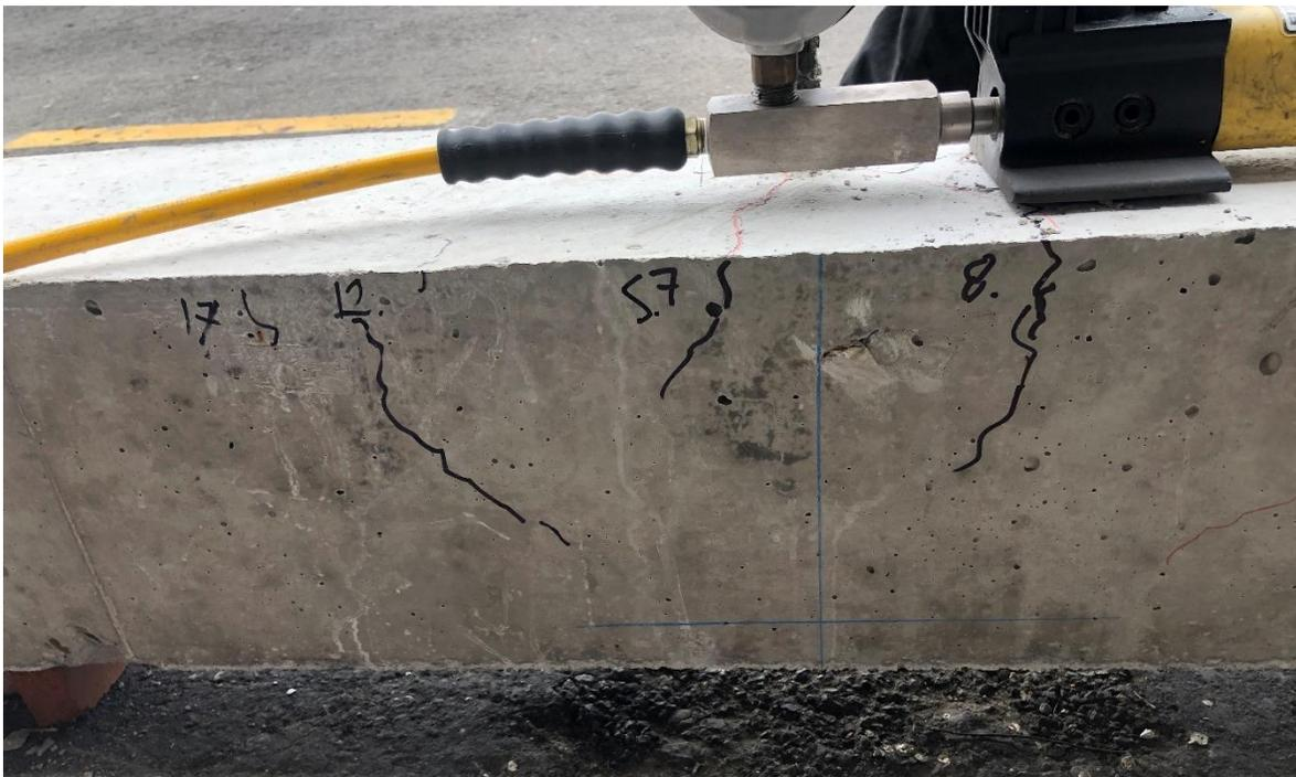
*Ilustración 89 Fisuras espécimen adicional barra #7. Fuente propia*
