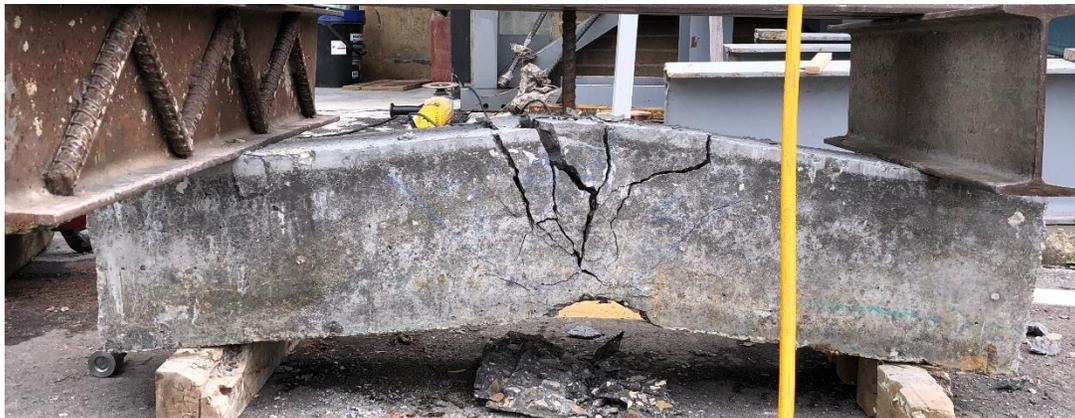
*Ilustración 86 Falla barra #6 ensayo inicial. Fuente propia*
