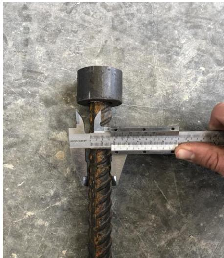
*Ilustración 34 Medición diámetro varilla #6. Fuente propia*
