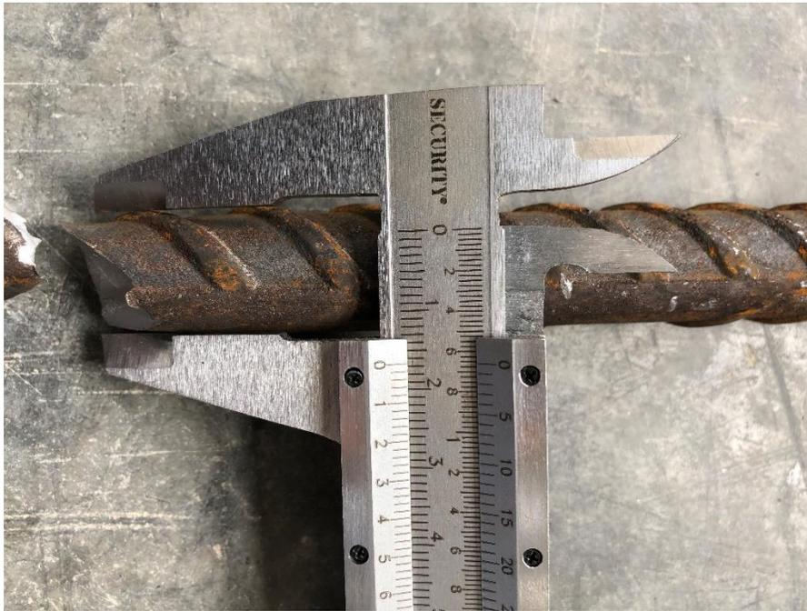
*Ilustración 53 Medición variación espesor en falla a tensión en barra. Fuente propia*
