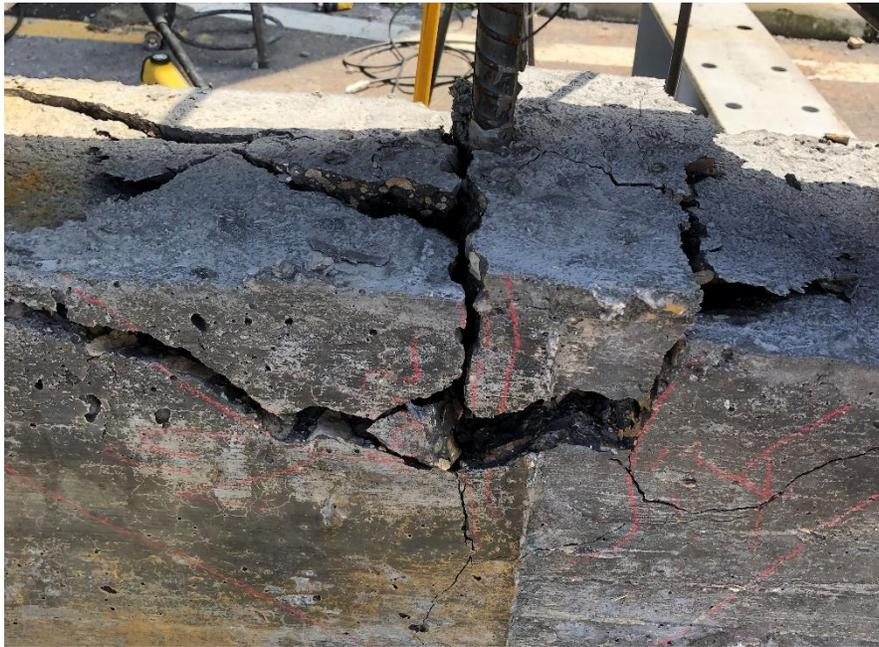
*Ilustración 60 Cono de falla Muestra #5. Barra # 7 profundidad 15 cm. Fuente propia*
