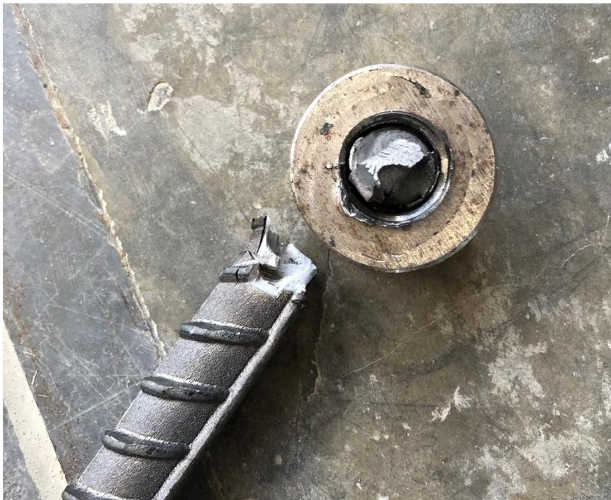
*Ilustración 54 Falla a tensión cercana a la conexión. Fuente propia*
