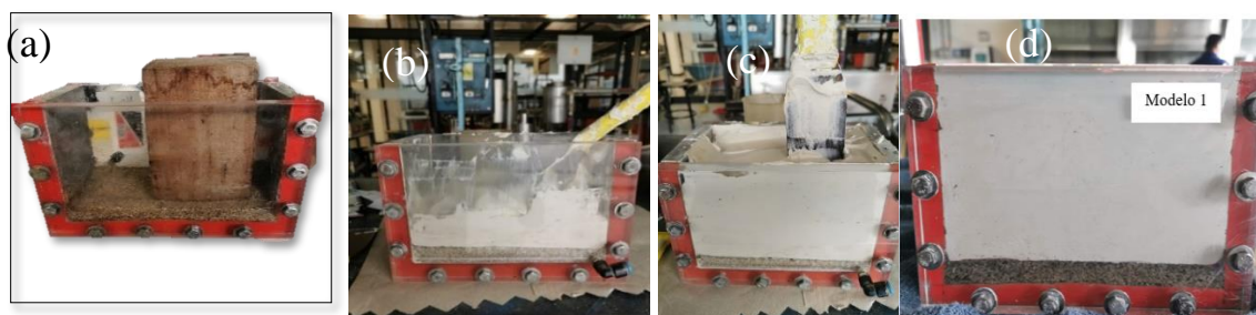
Figura N° 27. Proceso de consolidación (a) capa de material drenante en la caja nivelada (b) papel filtro, y sobre este, capas del suelo homogéneo sin refuerzo (c) caja llena de material dejando un espacio de 0.5 cm libre al final (d) resultado. Fuente propia.
