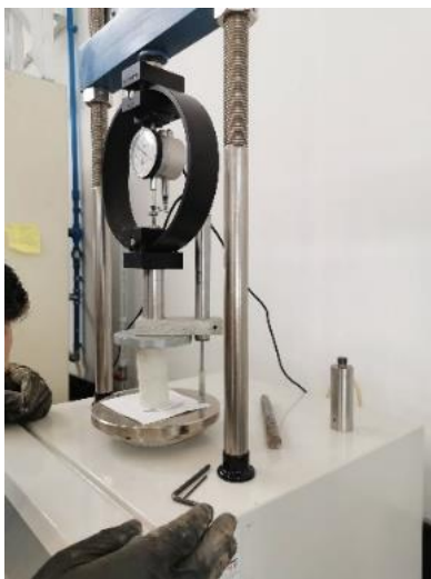
Figura N° 43. Montaje del ensayo de compresión inconfiada – suelo sin reforzamiento artificial. Fuente propia
