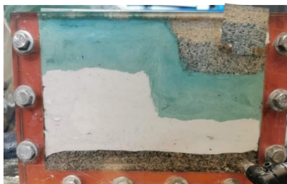
Figura N° 33. Modelación física de talud con sistema de reforzamiento Tipo IV (7.34% fibras de vidrio – 3.0 m profundidad de refuerzo del prototipo). Fuente propia
