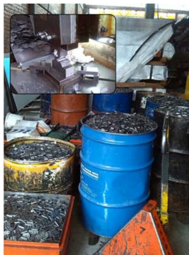
Figura 10: Piezas de trabajo en proceso de la empresa productora de herrajes metálicos. Algunas piezas son fabricadas a una tasa del orden de miles de unidades por día, y los inventarios como el de la imagen son del orden de millones de unidades.
