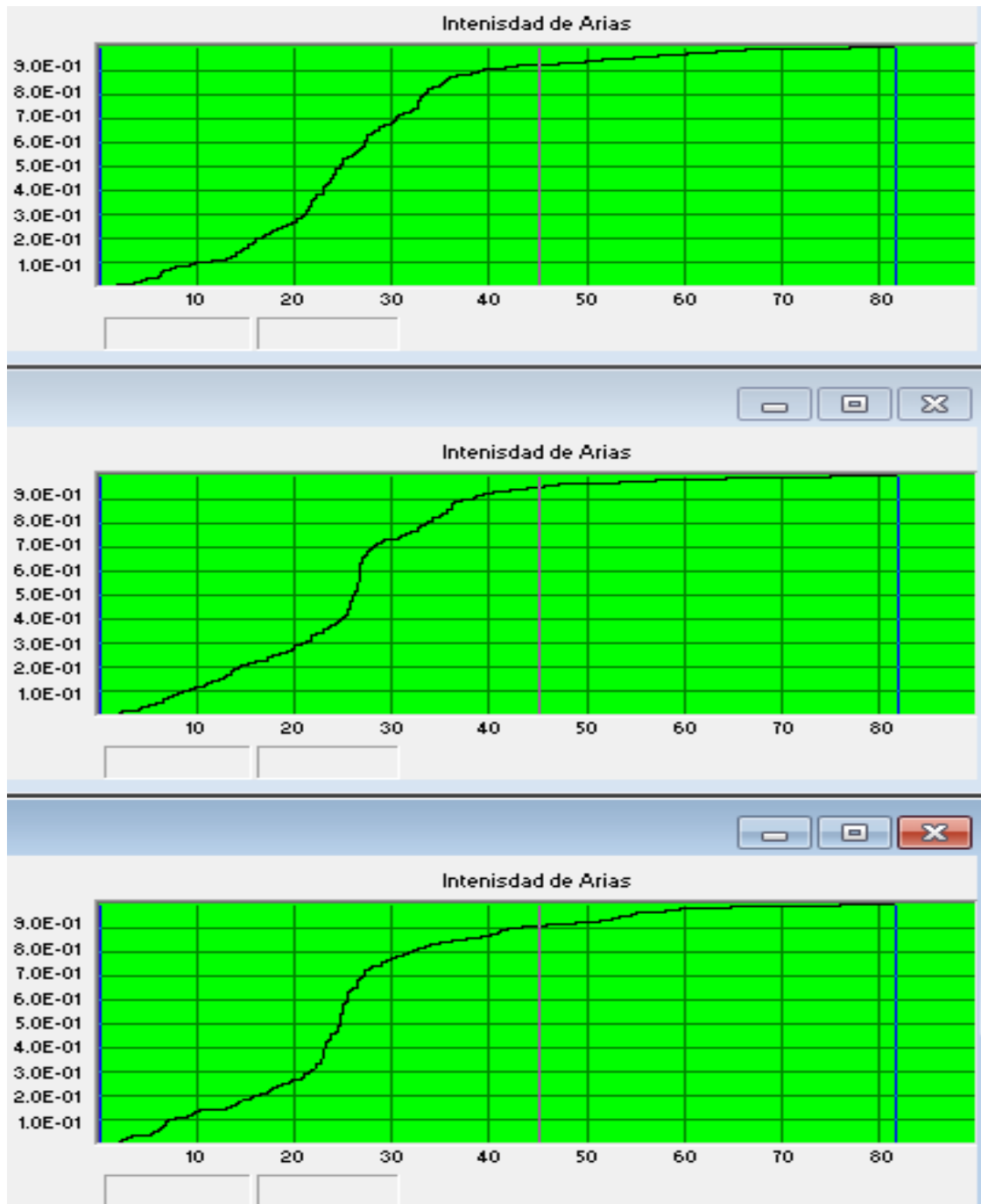
INTENSIDAD DE ARIAS, REGISTRO EN ROCA, ESTACION CUAGR, SISMO QUETAME 2008, NS (inf.), V (medio) y EO (sup.), CON CORRECCION DE LINEA BASE Y FILTRO PASABANDA
