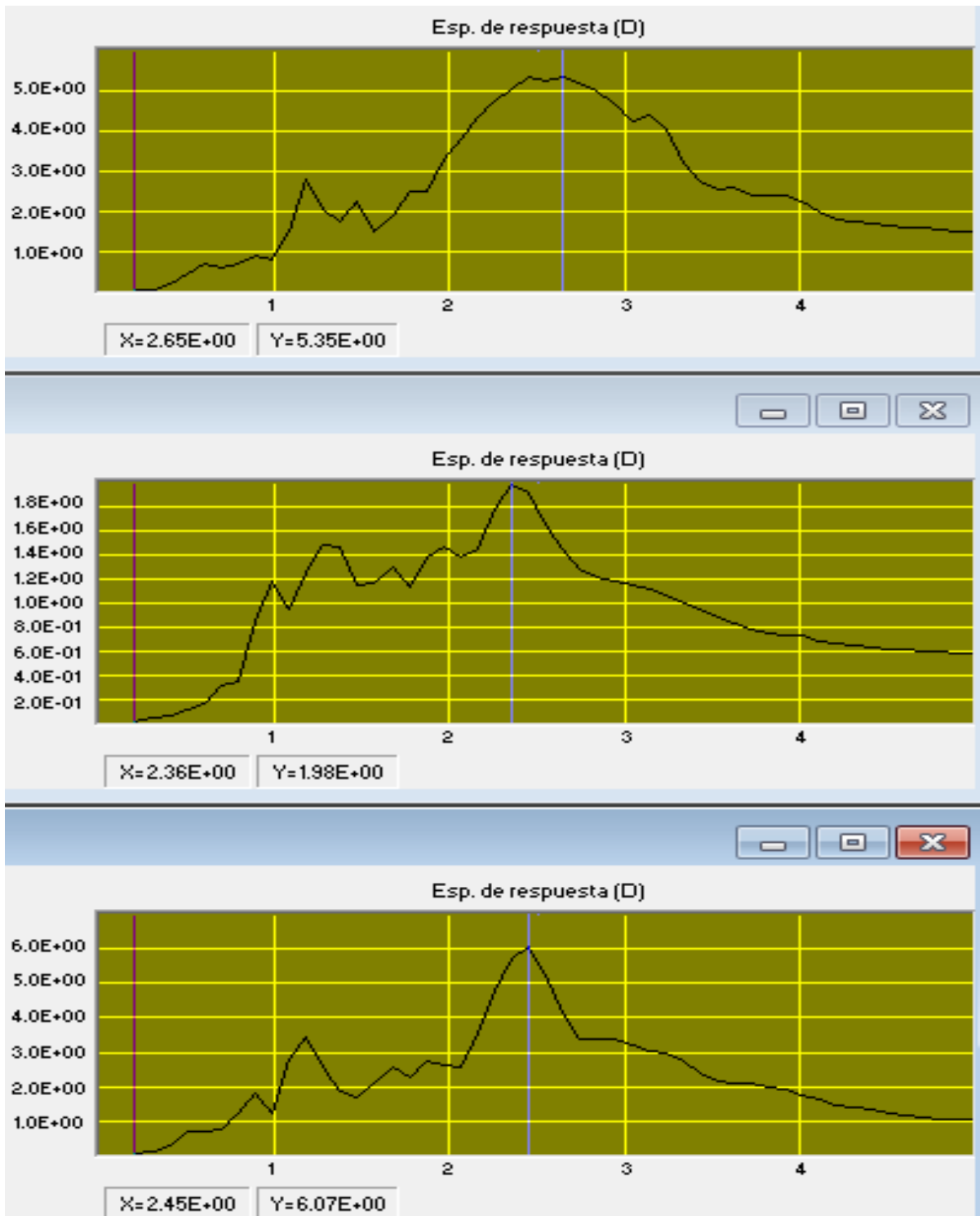
ESPECTRO DE RESPUESTA DE DESPLAZAMIENTO, ESTACION CBOSA, SISMO QUETAME 2008, EO (inf.), V (medio) Y NS (sup.), AMORTIGUAMIENTO 2% DEL CRITICO
