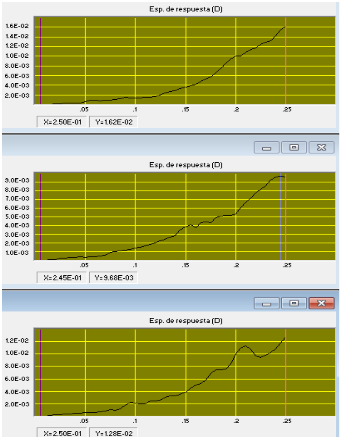
ESPECTRO DE RESPUESTA DESPLAZAMIENTO, ESTACION CUAGR-REGISTRO EN ROCA, SISMO QUETAME 2008, EO (inf.), V (medio) Y NS (sup.), AMORTIGUAMIENTO 5% DEL CRITICO
