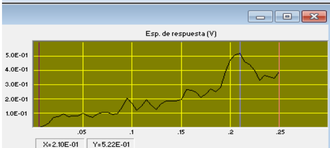
ESPECTRO DE RESPUESTA VELOCIDAD, ESTACION CUAGR-REGISTRO EN ROCA, SISMO QUETAME 2008, EO (inf.), V (medio) Y NS (sup.), AMORTIGUAMIENTO 2% DEL CRITICO
