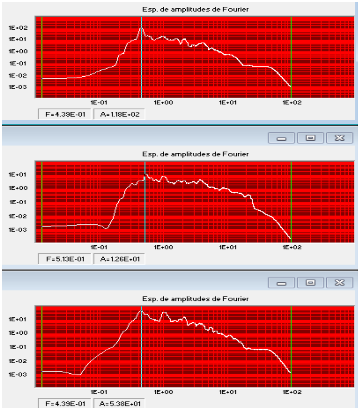
ESPECTRO DE AMPLITUDES DE FOURIER, ESTACION CUAGR-SUPERFICIE, SISMO QUETAME 2008, EO (inf.), V (medio) Y NS (sup.)
