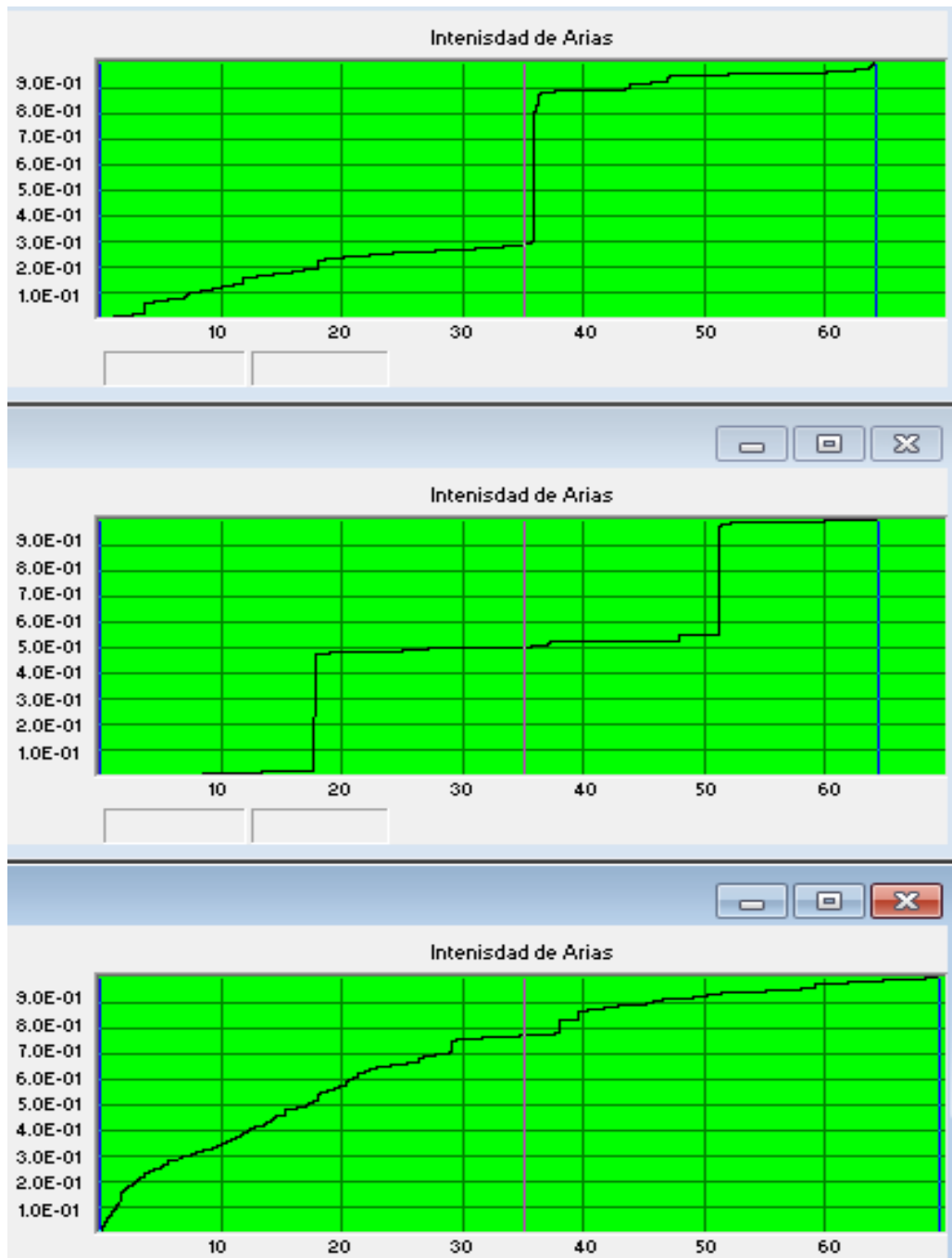
INTENSIDAD DE ARIAS, ESTACION CUAGR-ROCA, SISMO QUETAME 2008, EO (inf.), V (medio) Y NS (sup.) DECONVOLUCION-DEGTRA A4
