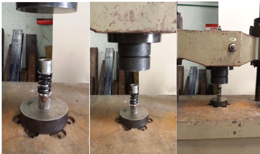
Figura 4-1: Proceso del ensayo a compresión en un resorte tipo
