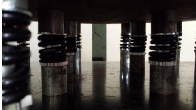
Figura 4-20: Deformación de los resortes 2
