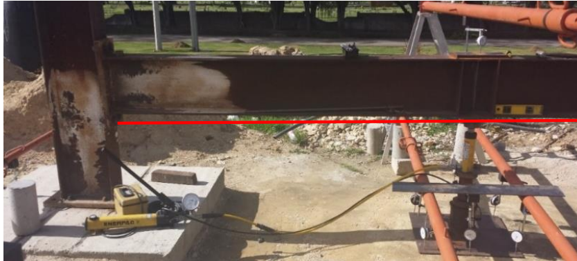
Figura 4-38: Deformación en viga IPE360 durante el ensayo de platina 1/4"
