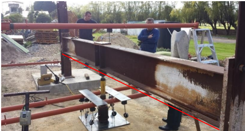
Figura 4-28: Deformación en viga IPE360 durante el ensayo de platina 3/8"
