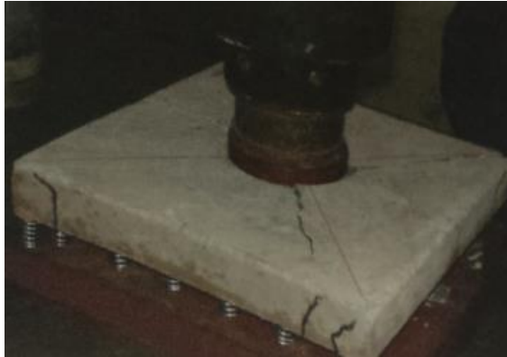
Figura 2-4: Estructura del ensayo para cimentación aislada (zapatas en concreto)
