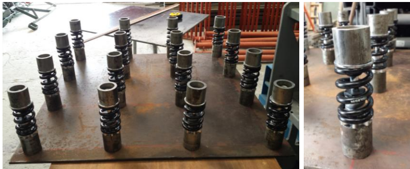
Figura 4-9: Base metálica con resortes 1
