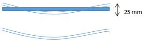
DEFORMACION OBTENIDA EN LA PLATINA SOBRE RESORTES
