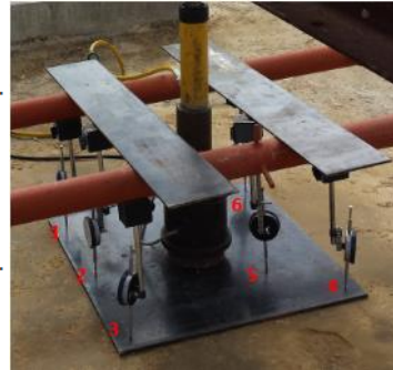
Figura 4-42: Comparativo de resultados de deformación para puntos de deformímetro en platina 1/4" sobre recebo
