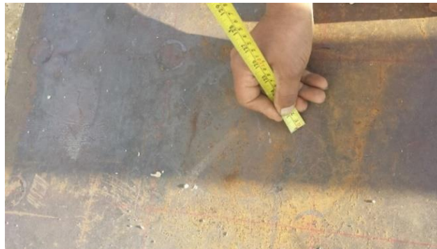
Figura 4-41: Zonas de sobreesfuerzo en la platina 1/4 después del ensayo
