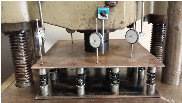
Figura 3-1: Modelo tipo de platina metálica sobre resortes
