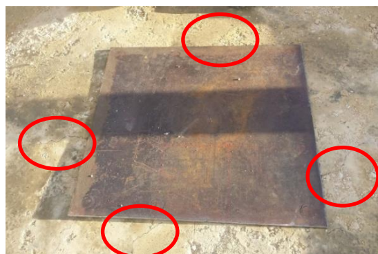
Figura 4-40: Fisuración en el recebo durante el ensayo de platina 1/4
