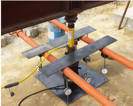
Figura 3-2: Modelo tipo de platina metálica sobre recebo
