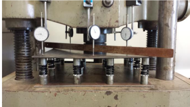
Figura 4-11: Deformación de la platina 3/8" apoyada sobre resortes
