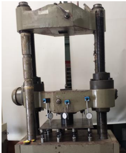
Figura 4-10: Ensayo a compresión de la platina 3/8" apoyada sobre resortes
