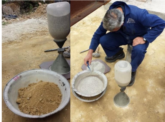
Figura 4-26: Toma de muestra para densidad y compactación del recebo 1
