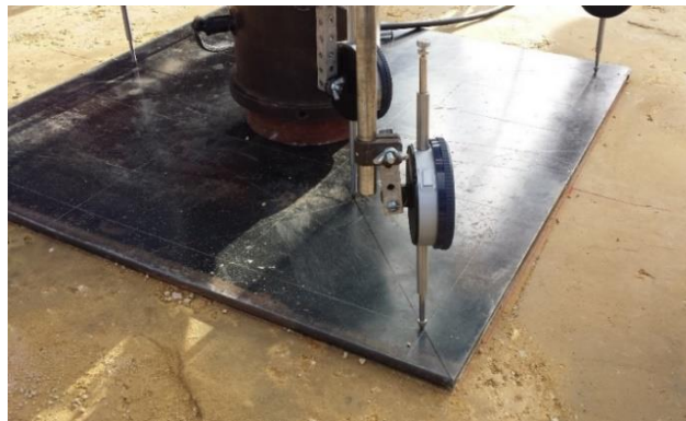
Figura 4-29: Deformación del recebo y platina durante el ensayo de platina 3/8
