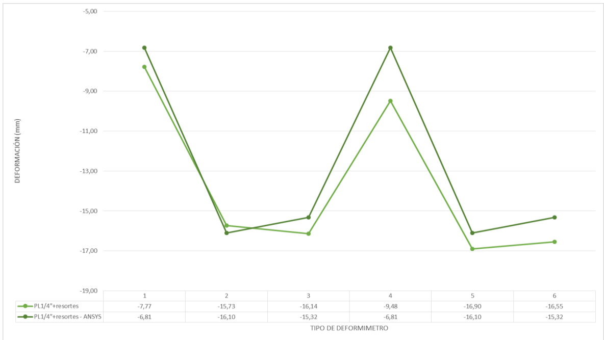
Figura 5-16: Comparativo de deformaciones Ensayo vs ANSYS para la platina 1/4"
