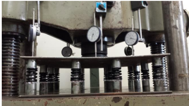
Figura 4-19: Deformación de la platina 1/4" apoyada sobre resortes
