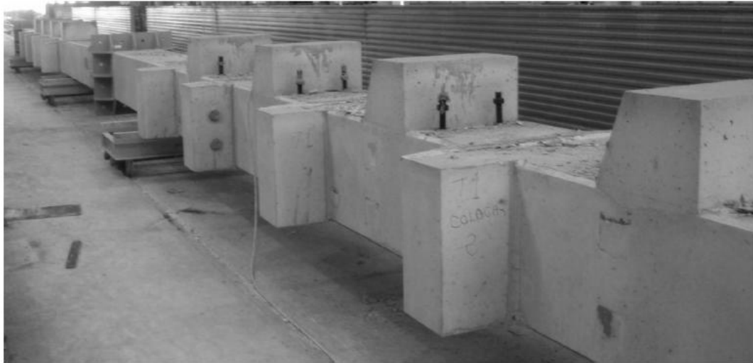
Figura 35 banco de prefabricación para columnas con alturas diferentes de entrepiso
