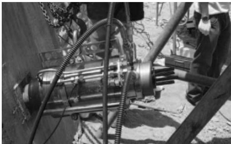
Figura 2. Sistema de tensionamiento hidráulico de torones utilizado actualmente
