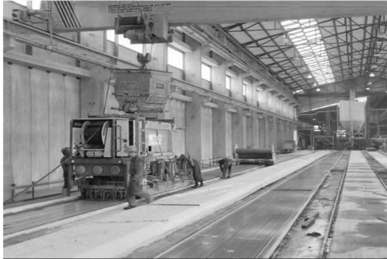
Figura 10 .Banco de prefabricación de losas alveolares – Manufacturas de cemento S.A
