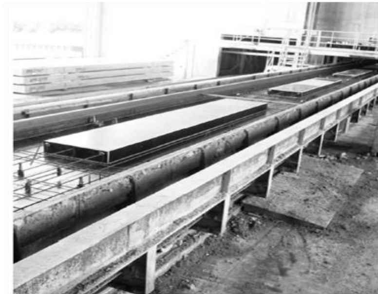
Figura 4. Formaleta en cama de acero para elementos prefabricados (Moldes)
