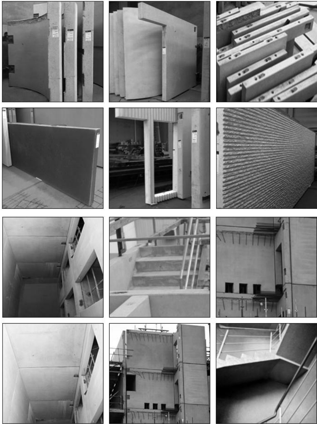
Figura 41 Fabricación Industrial de Paneles y escaleras prefabricados
