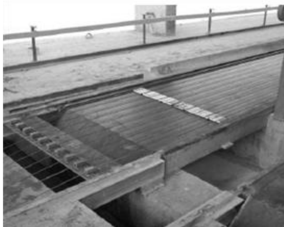
Figura 7. Formaleta en acero para losas alveolares
