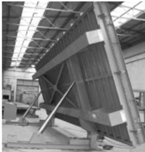
Figura 9. Formaleta en acero para Muros en fábrica
