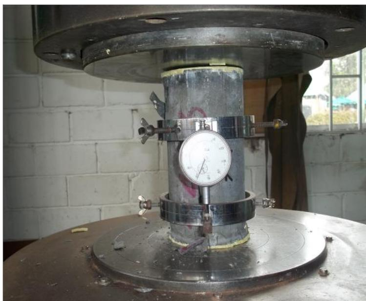
A continuación se presentan los datos obtenidos en laboratorio (esfuerzos vs deformación unitaria) para el módulo de elasticidad, iniciando con la mezcla patrón de uso común de 21 MPa y continuando con las mezclas de 42,49 y 56 MPa. Al final se presenta una tabla resumen de los resultados obtenidos en el laboratorio aplicando la norma ASTM-C469 y comparándola con la norma nacional NSR10 y el ACI-318S-11.
