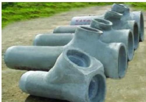
Son elementos de concreto sin refuerzo para diámetros inferiores a 100 cm que permiten realizar cambios de alineación en las redes de alcantarillado y ejecutar conexiones de tubería, según las necesidades de cada proyecto.
