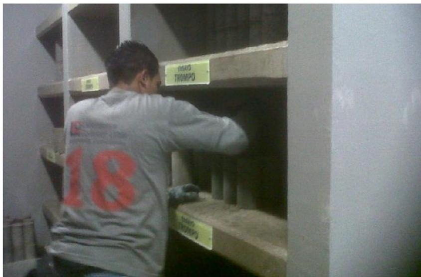
En la Fotografía 2, se observa el curado de las muestras 21, 42, 49 y 56 MPa, ensayadas en este documento, que mantiene en el material las condiciones de humedad y temperatura ideales para desarrollar su resistencia y desempeño.
