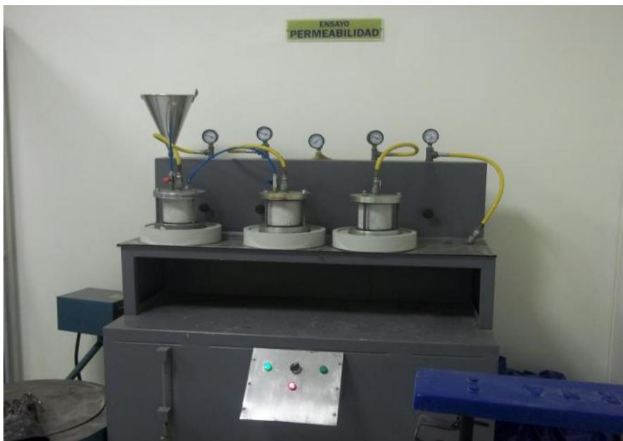
El ensayo de permeabilidad, permite conocer la cantidad de migración de agua a través de los poros del concreto cuando el agua se encuentra a presión, determinando una medida de la capacidad del concreto a resistir la penetración del agua. Para el ensayo de estos especímenes se elaboraron y curaron de acuerdo con la NTC 1377 (ASTM -C192).
