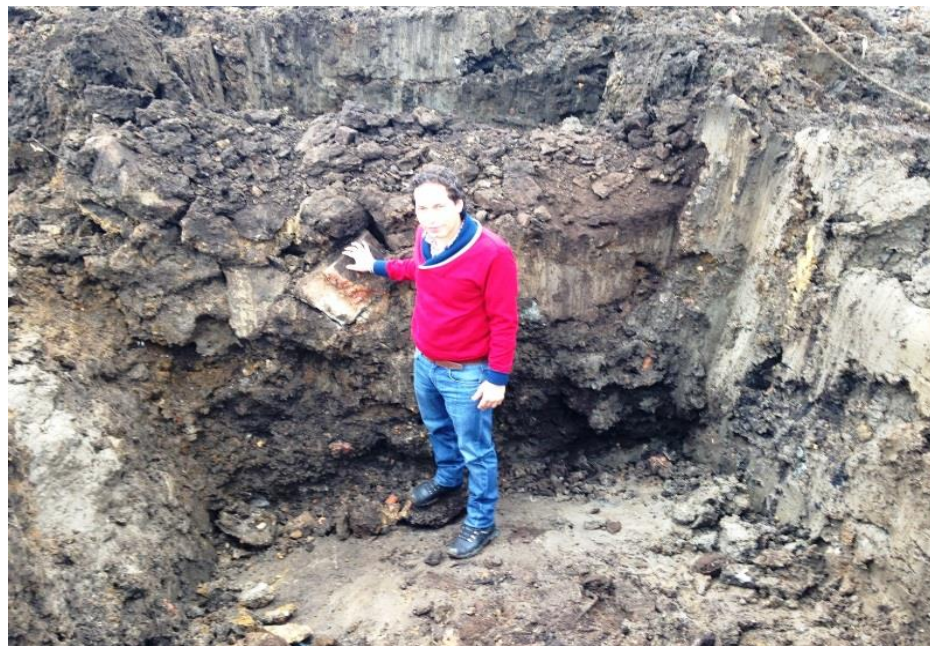
Figura 13 Cuando el perfil de suelo está conformado por arcilla, las depresiones son muy grandes, mayores de 1.8m.
