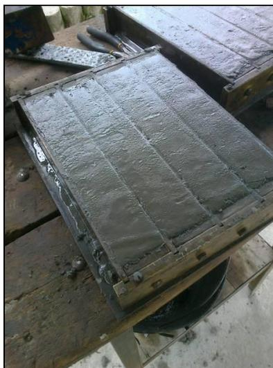
**Figura 15. Probetas obtenidas para ensayos de contracción.**
