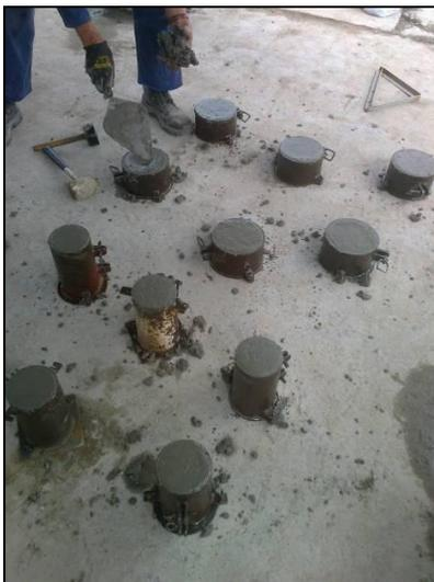
**Figura 14. Probetas obtenidas para ensayos de resistencia a la compresión e ISAT.**
