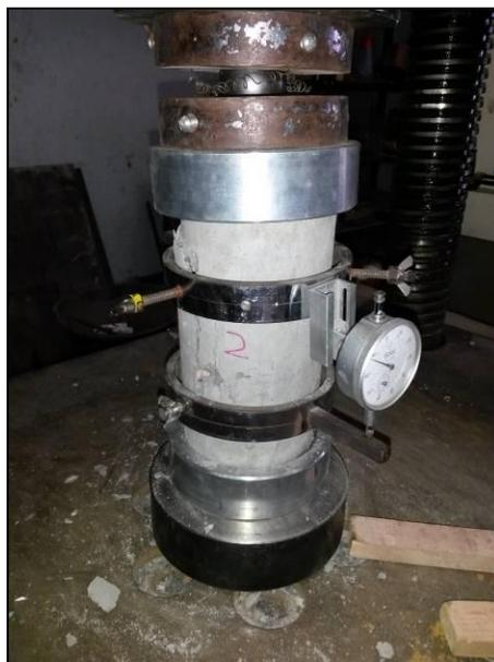
**Figura 18. Ensayo de módulo de elasticidad.**
