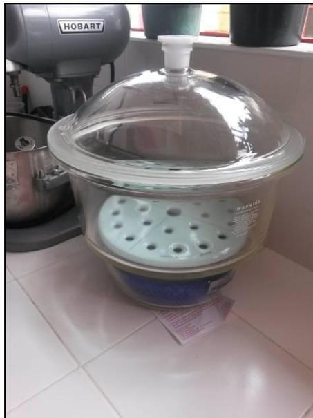
**Figura 21. Desecador usado para controlar la humedad relativa de las muestras.**
