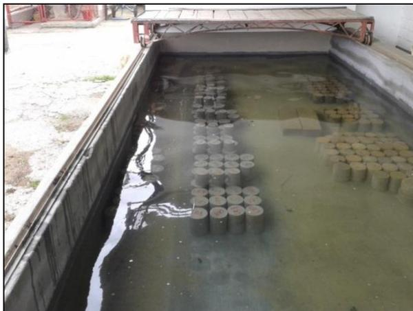
**Figura 12. Piscina de curado para muestras de concreto.**
