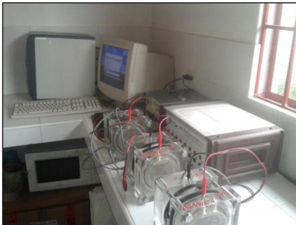
**Figura 19. Montaje de ensayo de permeabilidad al ion cloruro.**
