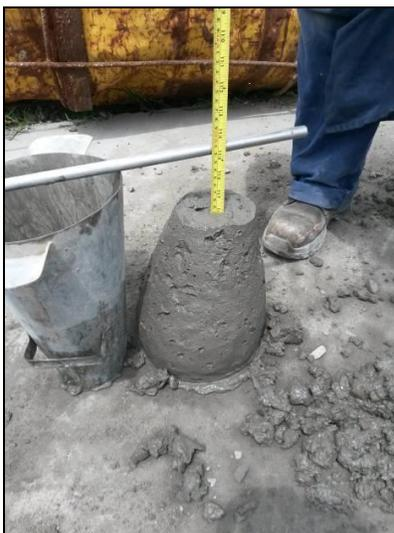
**Figura 16. Ensayo de asentamiento para la mezcla MC40-0.50.**
