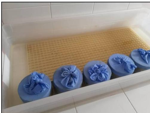
**Figura 20. Montaje para el ensayo de sortividad.**
