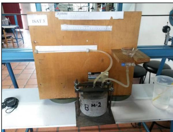
**Figura 24. Montaje del equipo para el ensayo de ISAT.**
