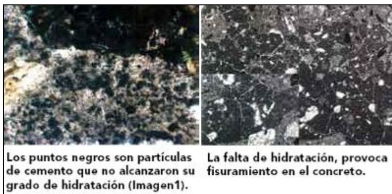
**Figura 1. Partículas de cemento no hidratadas - Centro de Tecnología y Concreto de CEMEX – CTCC<sup>2</sup>.**
