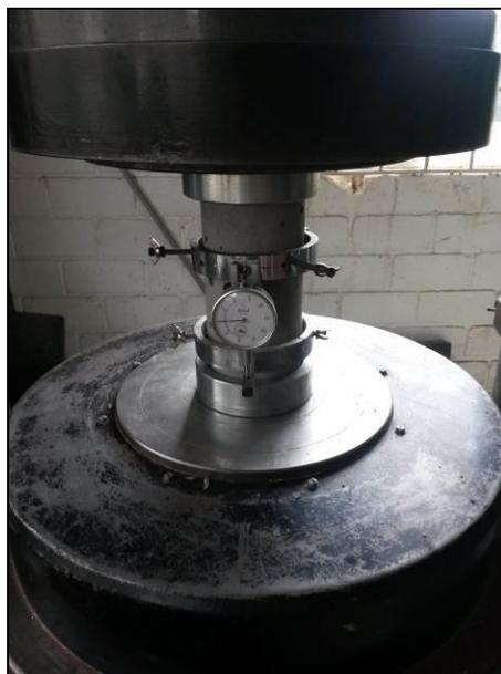
**Figura 17. Prensa hidráulica para ensayos de resistencia a la compresión.**
