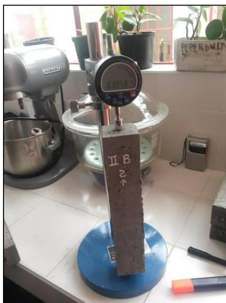
**Figura 23. Medición de contracción en las muestras de concreto.**
