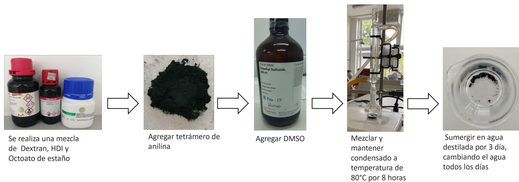
Figura 3.5: Diagrama de la metodología empleada para síntesis del hidrogel.
