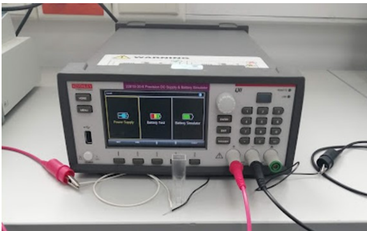
Figura 3.7: Montaje para la medición de la conductividad eléctrica.
