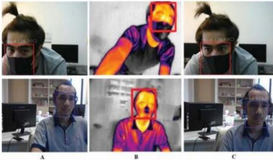
Figura 7. Salidas del módulo A y B con su respectiva superposición C [17].
